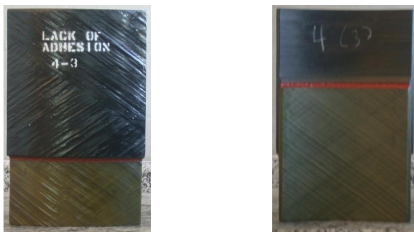
(a) (b) Figura 21 - Seção de uma junta de 16" fornecida pelo fabricante (a) superfície externa e (b) superfície interna
