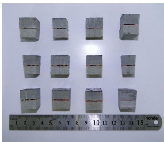
Figura 50 – Algumas seções do corpo de prova sem defeito que apresentaram ausência de adesivo
