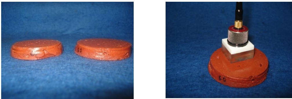
Figura 33 - (a) Corpos de prova do adesivo e (b) medição da velocidade do som com transdutor de 1 MHz e sapata acrílica
