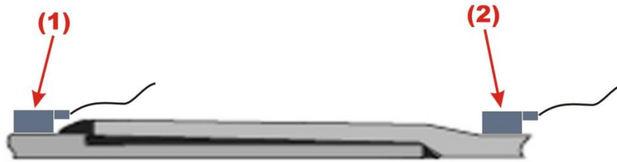
Figura 32 - Localização das regiões de medição de velocidade do som sem a presença de adesivo
