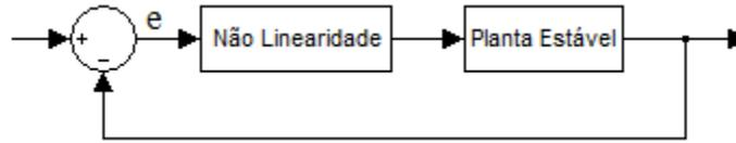
Figura 6.1: Representação de um sistema sobre o qual o critério de Popov pode ser aplicado
