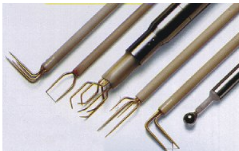
Figura 17. Anemômetros Térmicos por Fio-quente (Livro Freire et al)[7].
