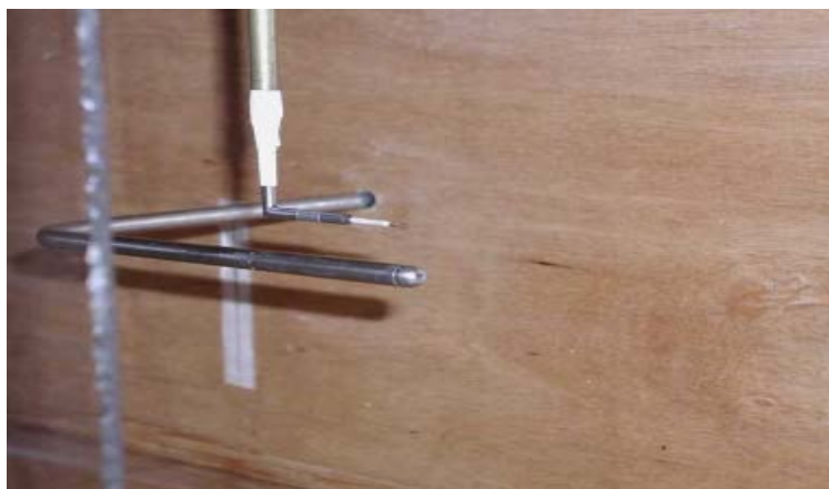
Figura 21. Calibração de Fio-Quente com Tubo de Pitot.
