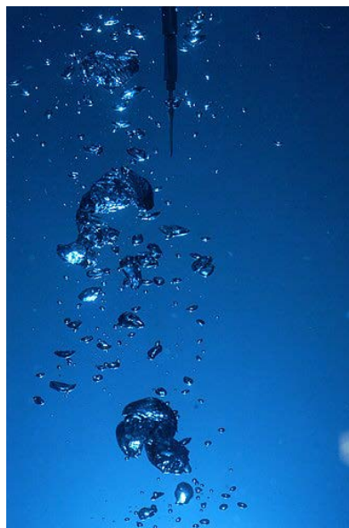
Figura 35. Sensor eletro-resistivo em escoamento bifásico ar-água.
