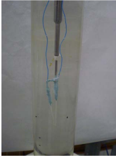
Figuras 84. Um sensor vertical e um inclinado dentro da coluna de teste.
