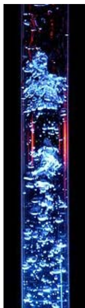
Figura 1. Escoamento Bifásico Ar-Água em Tubulação Vertical.
