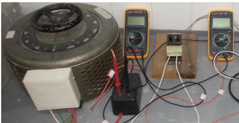
Figura 2.10 - Variac, amperímetro e multímetro digital no sistema de aquecimento.
