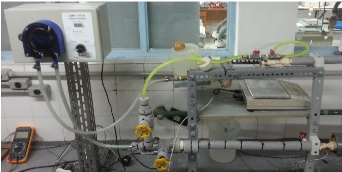
Figura 2.4 - Visão parcial do circuito onde podem ser vistos a bomba peristáltica, o reservatório, a balança de precisão e o sistema *by-pass*.
