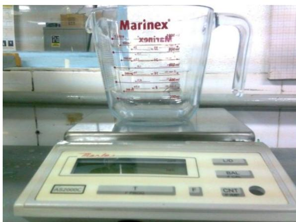
Figura 2.8 - Balança de precisão e recipiente usados na medição de vazão
