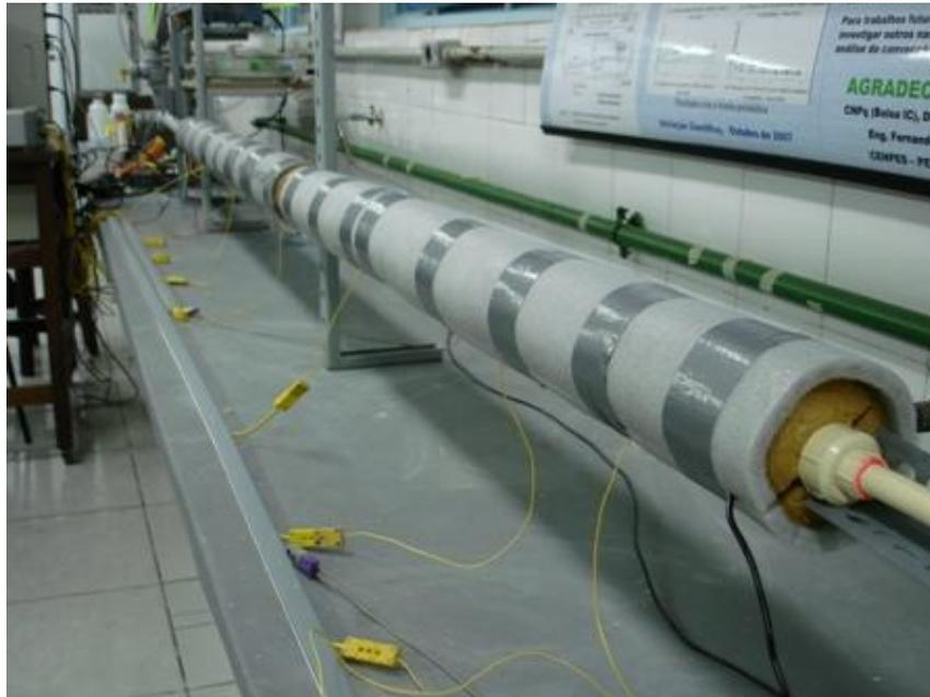
Figura 2.2 - Novo isolamento térmico da seção de testes após instalação.
