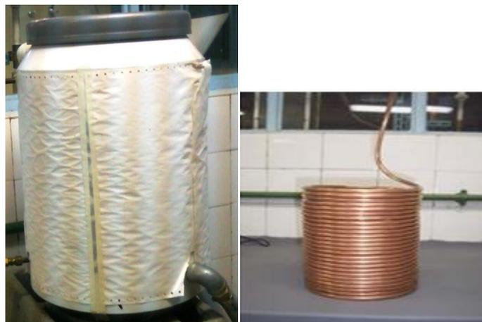
Figura 2.7 - (a)Trocador de Calor e (b) serpentina em detalhe.
