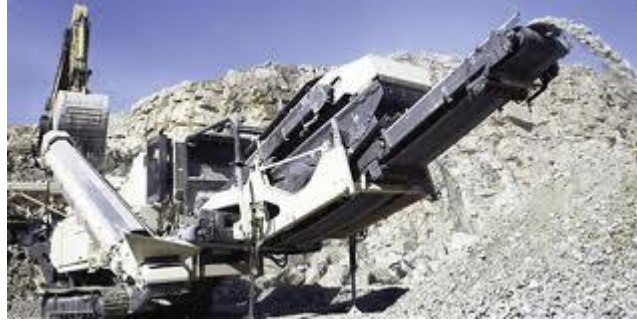
Figura 20 - Exemplo de planta móvel de reciclagem de RCD.
