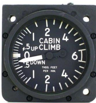
**Figura 2.11: Variômetro mecânico**
