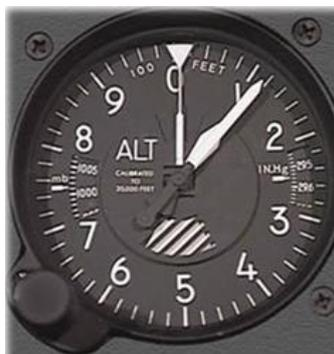
**Figura 2.10: Altímetro**
