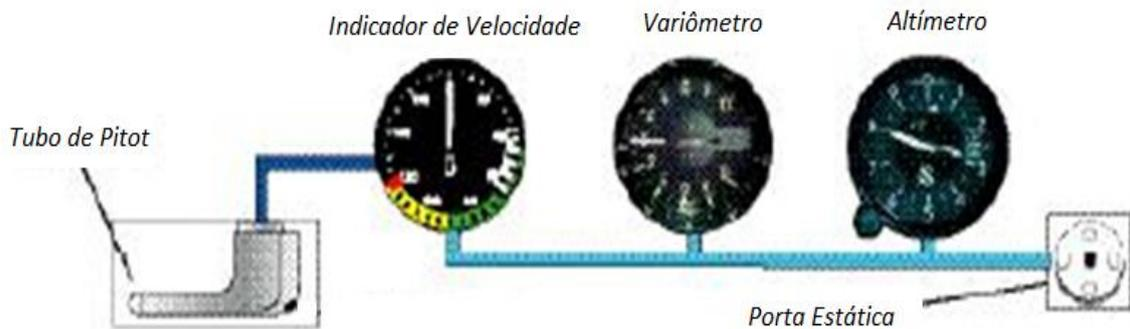
**Figura 2.8: Sistema pitot-estático [Fonte: Adaptado FEDERAL (2009)]**
