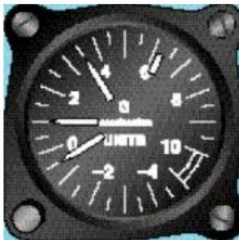
**Figura 2.12: Medidor de Força G [Fonte: Adaptado FEDERAL (2009)]**
