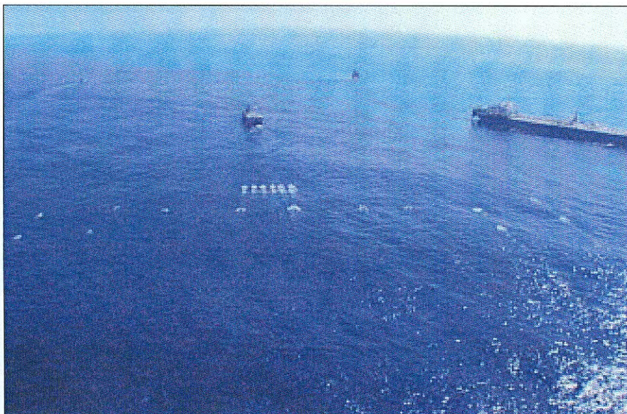
Figura 59: Navio sísmico realizando o levantamento ao lado das estruturas de produção do Complexo de Marlim.
