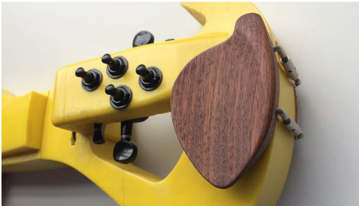
Figura 67 – colocação da queixeira
