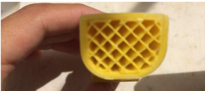
Figura 56 – peça quebrada: preenchimento 20%
