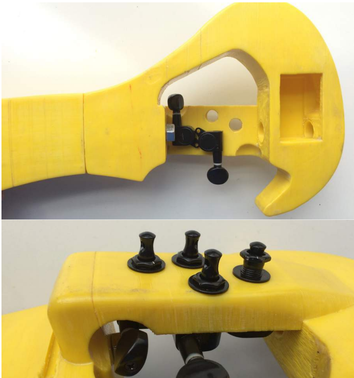
Figura 59 – colocação das cravelhas
