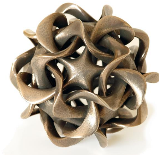
Figura 14: Dodecaedro feito de um compósito de aço e bronze pela SLS [1]
