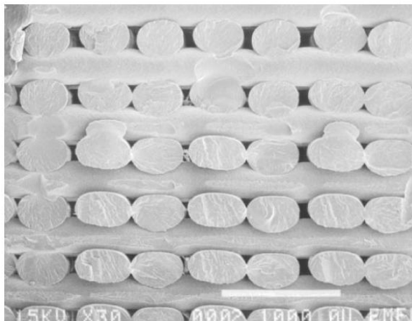
Figura 27: Vista de uma seção transversal de uma peça feita em ABS mostrando a existência de vazios [24]
