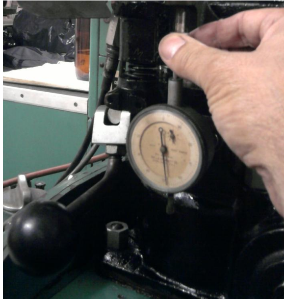
Figura 4.9 - Relógio comparador (micrômetro) que indica altura do cilindro
