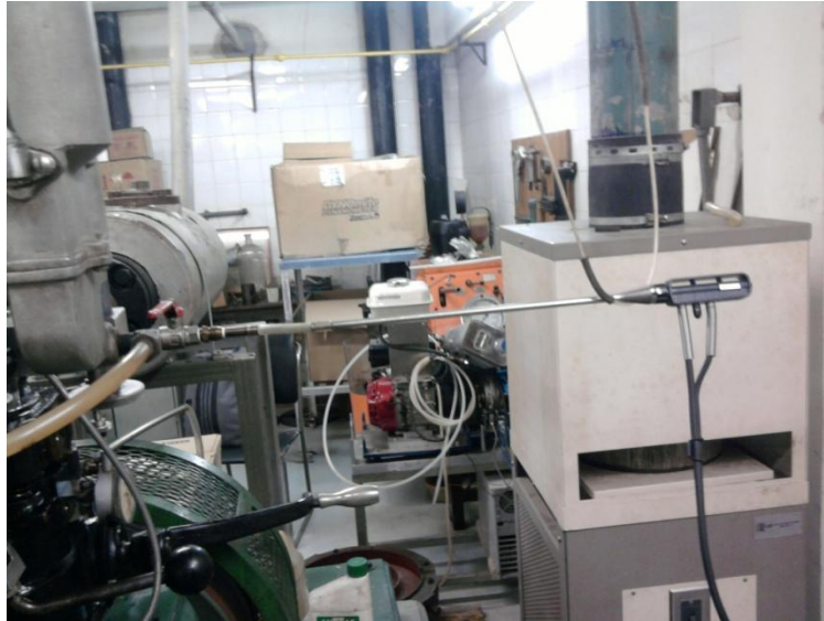
Figura 3.9 – Sonda acoplada ao escapamento do motor CFR
