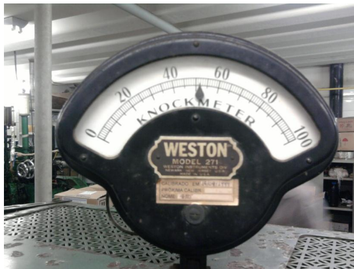
Figura 3.2 - Knockmeter do motor CFR
