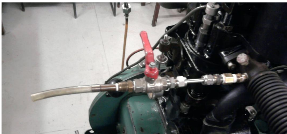
Figura 3.8 - Sistema de saída de gases para o analisador
