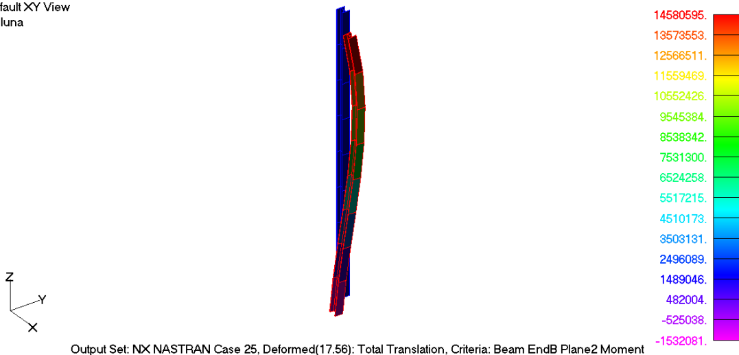
Figura 31 - Vista deformada da viga - Momento no plano 2
