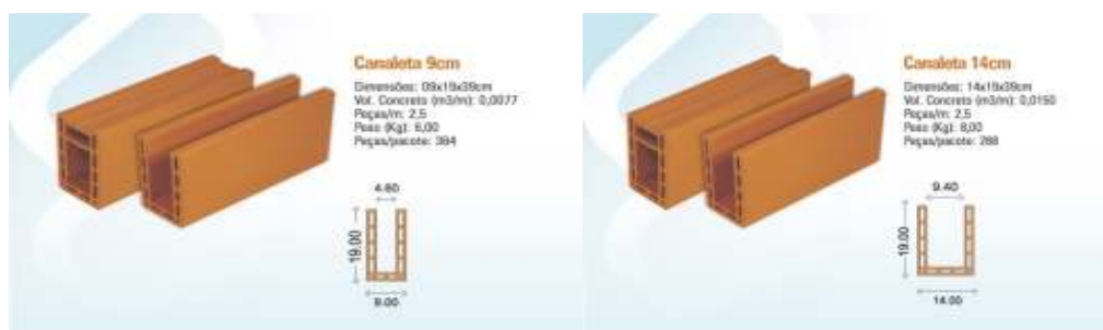
Figura 7 – Blocos canaleta (Fonte: selectblocos.com.br)
