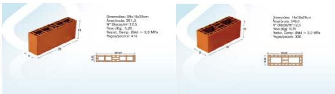
Figura 4 – Blocos modulares de largura 9 e 14 cm, normalmente usados em paredes internas e externas respectivamente (Fonte: selectabloco.com.br ).
