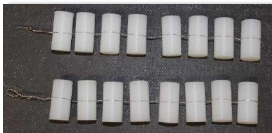
Figura 43 – Amostras cilíndricas para ensaios de tensão-deformação em compressão.
