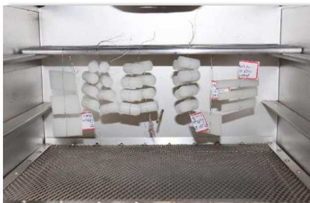
Figura 45 – Organização interna de materiais na estufa para o envelhecimento térmico.
