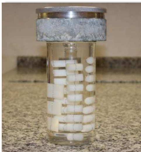
Figura 44 – Frasco de vidro utilizado para o envelhecimento do PVDF em etanol.
