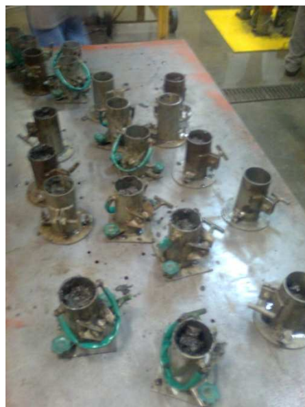
Figura 23 - Vibração e adensamento do concreto Fonte: Autor (2011)
