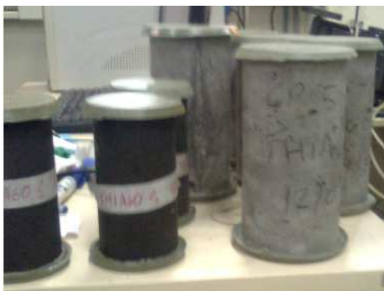
Figura 25 - Corpos-de-prova com a camada de pasta de enxofre para a regularização Fonte: Autor (2011)
