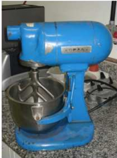
Figura 17 - Misturador usado no ensaio de demanda d'água Fonte: Autor (2012)
