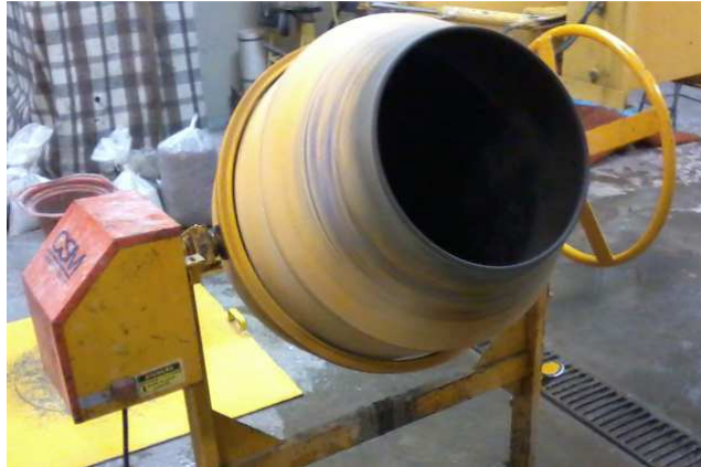
Figura 22 - Betoneira utilizada para mistura dos materiais Fonte: Autor (2011)
