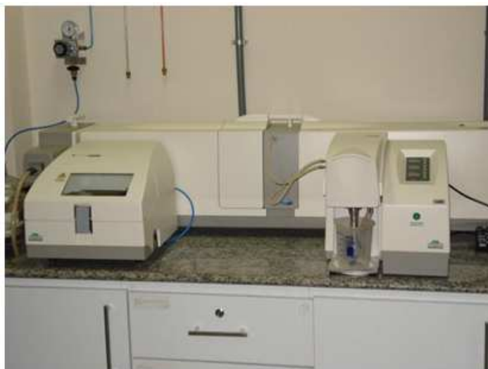
Figura 15 - Malvern : granulômetro a laser Fonte: Autor (2012)
