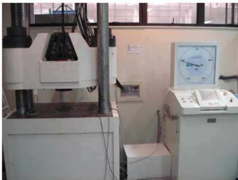
Figura 27 - Prensa Shimadzu servo-controlada, modelo UH-F 1000 kN Fonte: Autor (2011)
