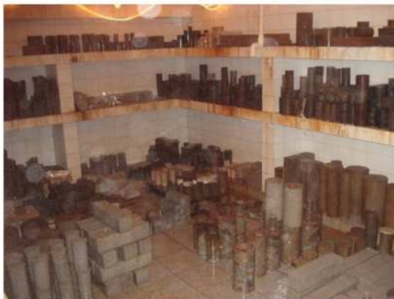
Figura 24 - Câmara úmida onde se deu a cura dos concretos Fonte: Autor (2011)
