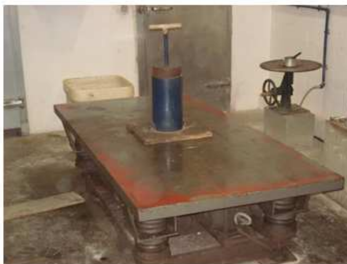
Figura 21 - Configuração do ensaio de compressão com vibração Fonte: Autor (2011)
