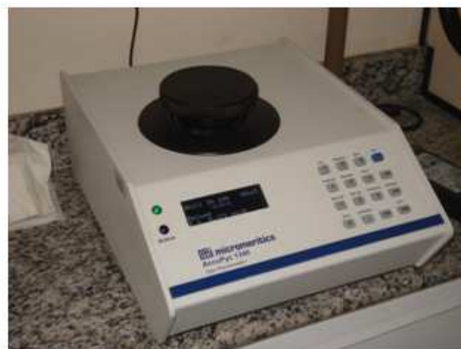
Figura 14 - Picnômetro utilizado para obtenção da massa específica Fonte: Autor (2012)
