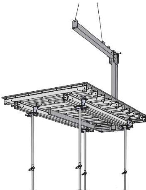
Figura 28 - Mesa sendo transportada com auxílio do garfo de translação e da grua (Fonte: Manual do fabricante - Doka)
