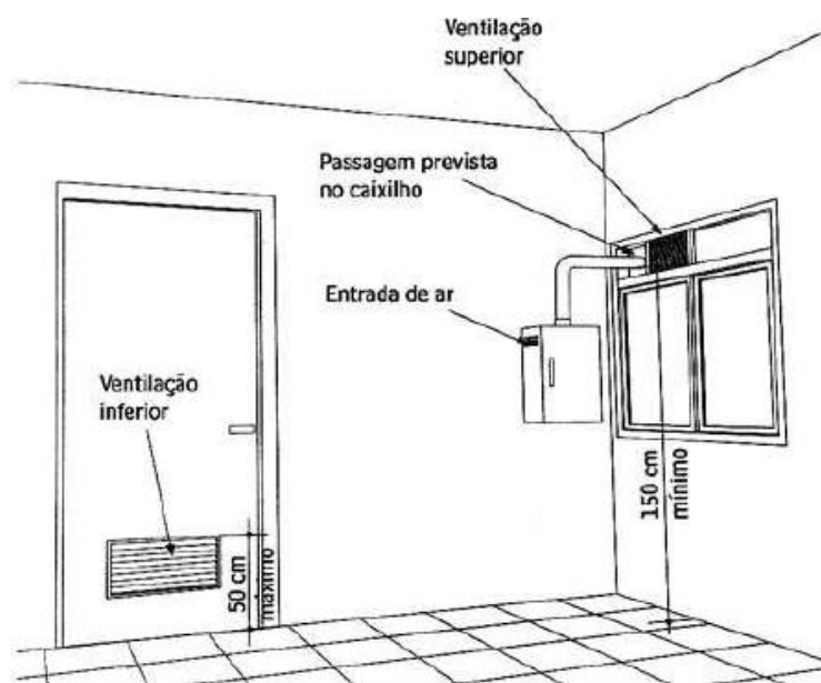
Figura 8: Distâncias mínima/máxima da ventilação.
