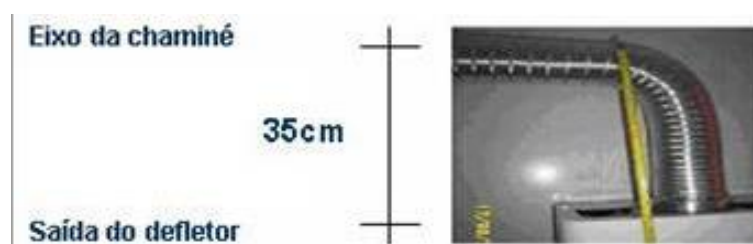
Figura 6: Distância mínima na vertical.
