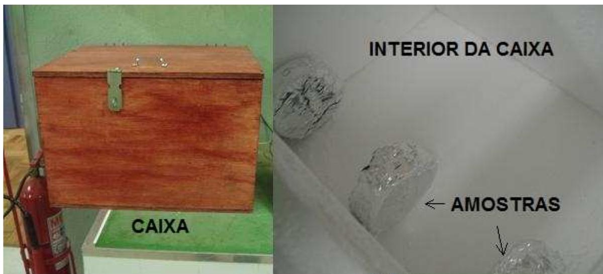
**Figura 26** – Caixa térmica elaborada para realização do ensaio de papel filtro
