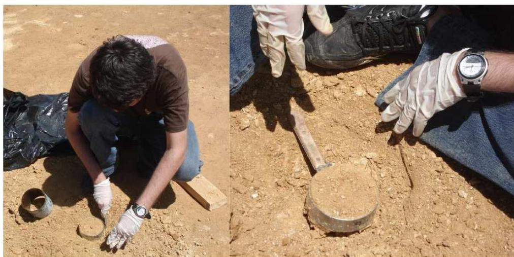
**Figura 24** – Coleta das amostras da argila amarela para ensaio de retenção
