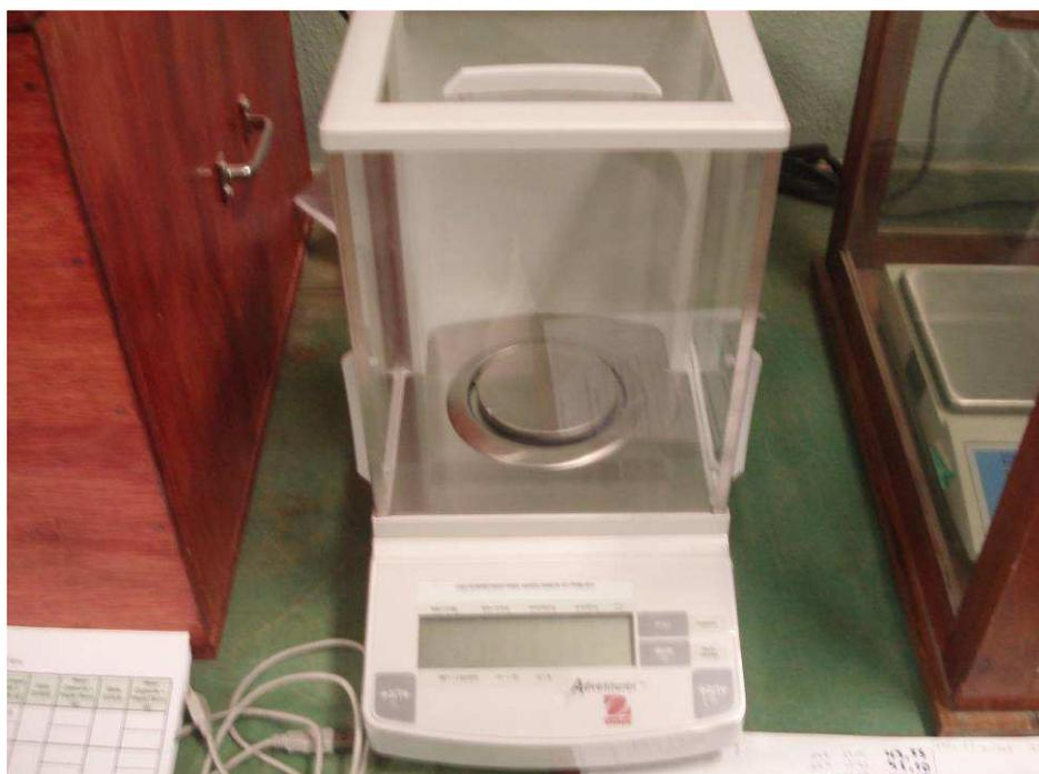
**Figura 27** – Balança de alta precisão utilizada
