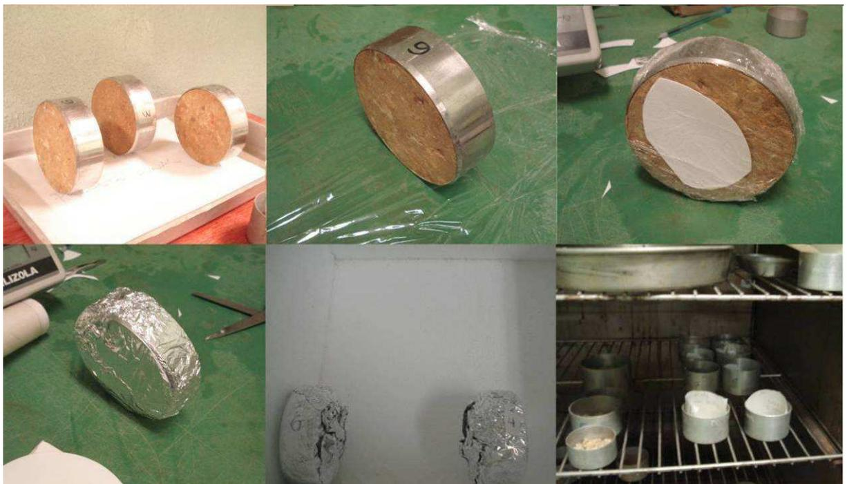
**Figura 29** – Sequência para medição da umidade do papel filtro
