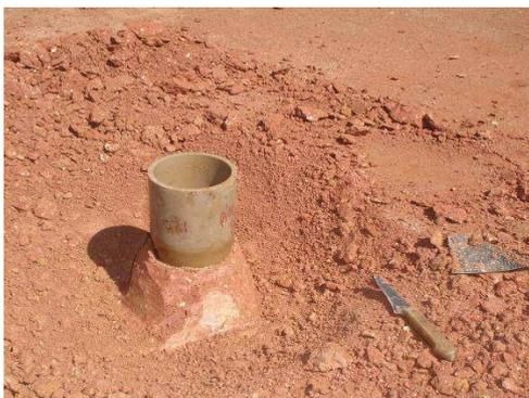
**Figura 25** – Amostragem indeformada para ensaio de permeabilidade
