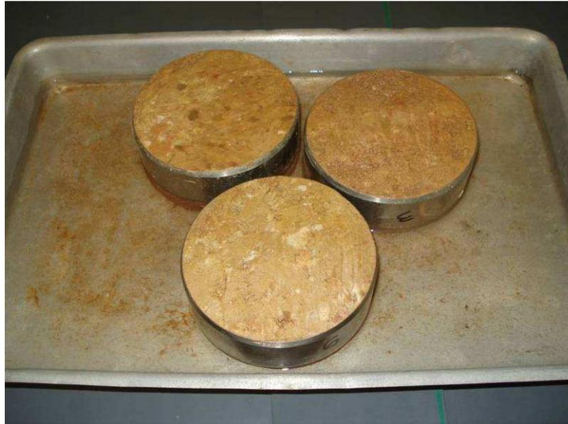
**Figura 28** – Saturação das amostras da argila amarela para ensaio de papel filtro
