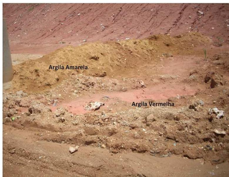
**Figura 23** – Materiais provenientes das jazidas, argila amarela e argila vermelha
