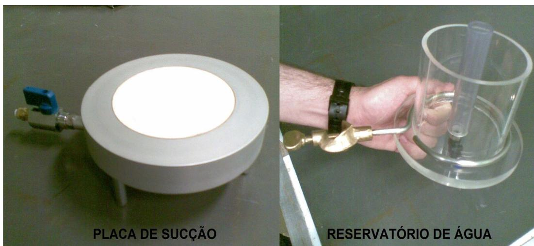
**Figura 6** – Equipamentos utilizados no ensaio de placa de sucção
