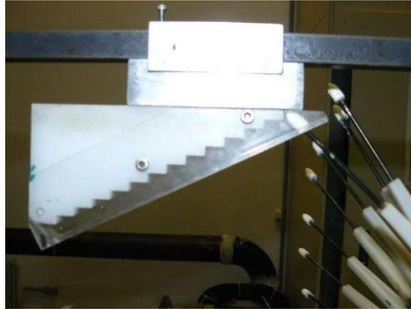
**Figura 1-5 Sensor palito sendo aferido no primeiro degrau do gabarito de calibração.**
