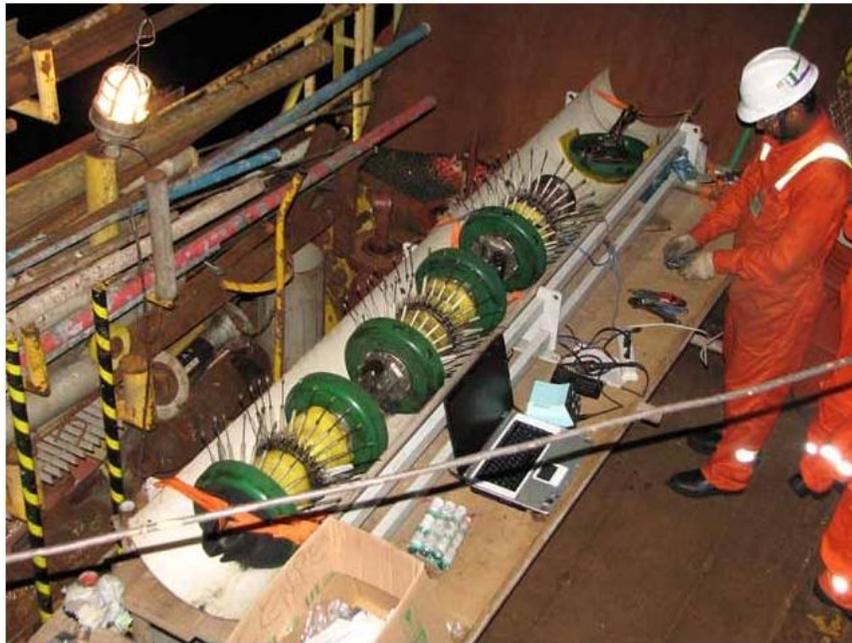
**Figura 1-4 Exemplo de PIG Palito**
