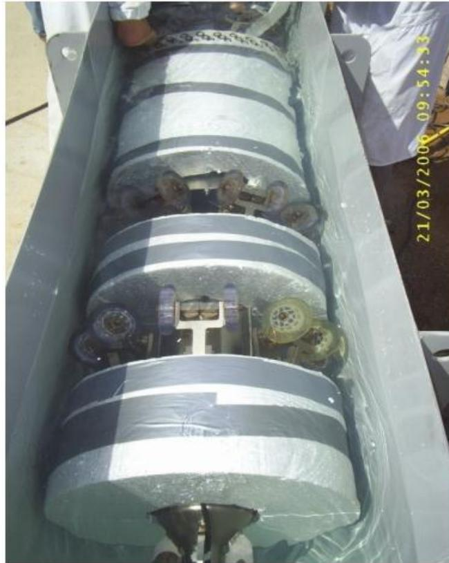
**Figura 1-3 PIG Ultrassom durante sua calibração.**
