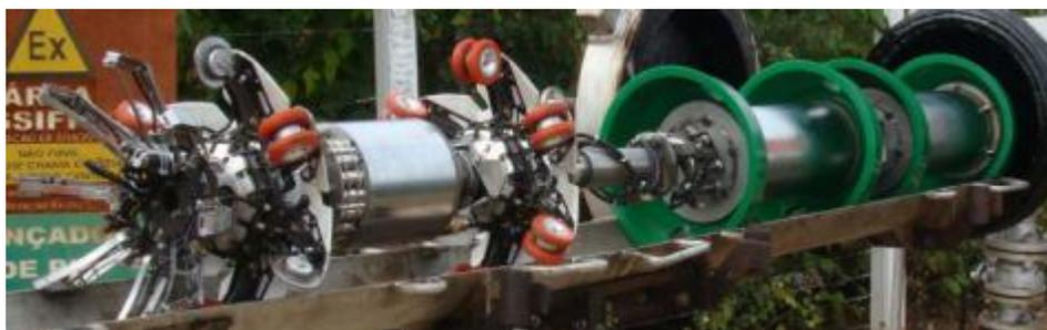
**Figura 1-1 Exemplo de PIG instrumentado.**
