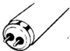
Figura 53 – Base do tipo bipino [3]
