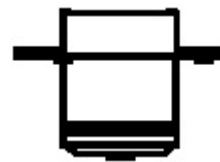
Figura 24 – Base tipo pré-focus [3]
