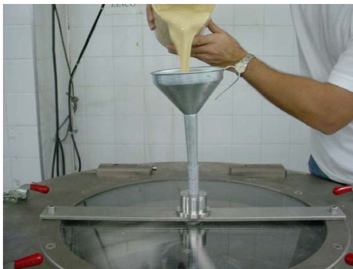
Figura 12 - Colocação da lama na centrífuga com aceleração de 5g.
