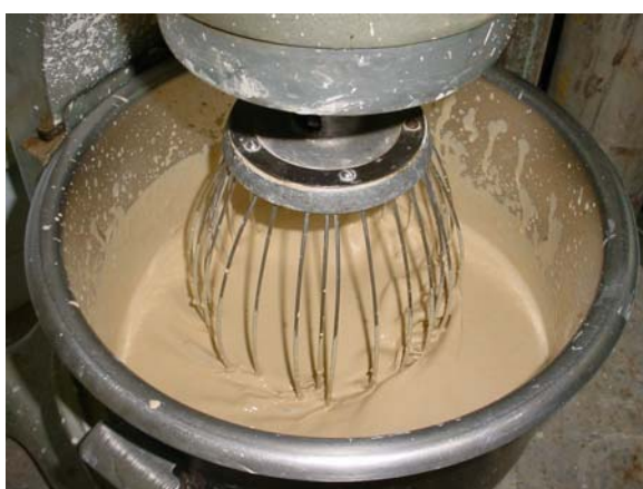
Figura 10 - Homogeneização das amostras: a) mistura da amostra na batedeira; b) verificação da homogeneidade da mistura.
