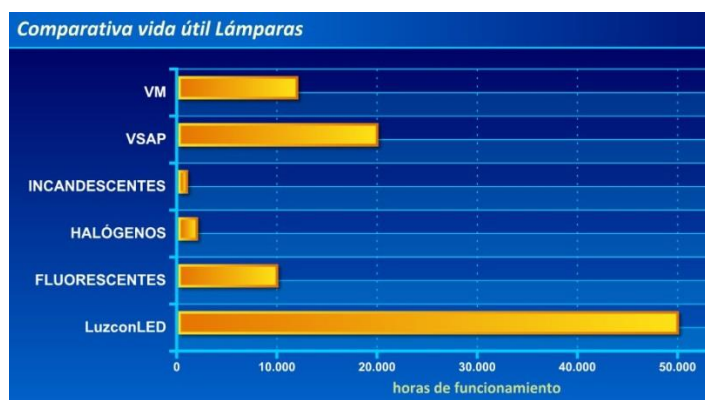
Figura 19-Comparação da vida útil das lâmpadas existentes no mercado (22)
