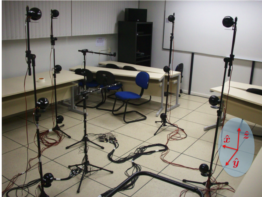
Figura 4.18: Setup utilizado no experimento prático. Há 12 alto-falantes (esferas pretas na imagem), e 16 microfones.
