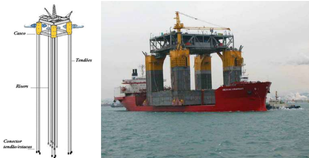
Figura 7: Plataforma com pernas tracionadas (TLP) - Plataforma com pernas tracionadas (TLP) durante o transporte. [2]
