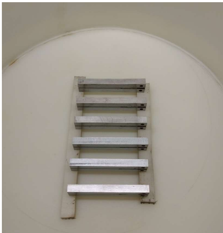
Figura 47 – corpos de prova dentro dos vasos.
