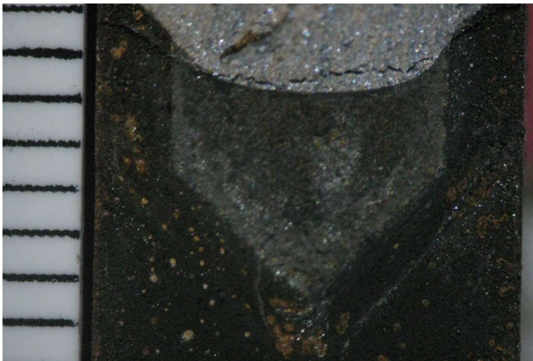
Figura 52 – Exemplo de corpo de prova sem ocorrência de corrosão sobre tensão.
