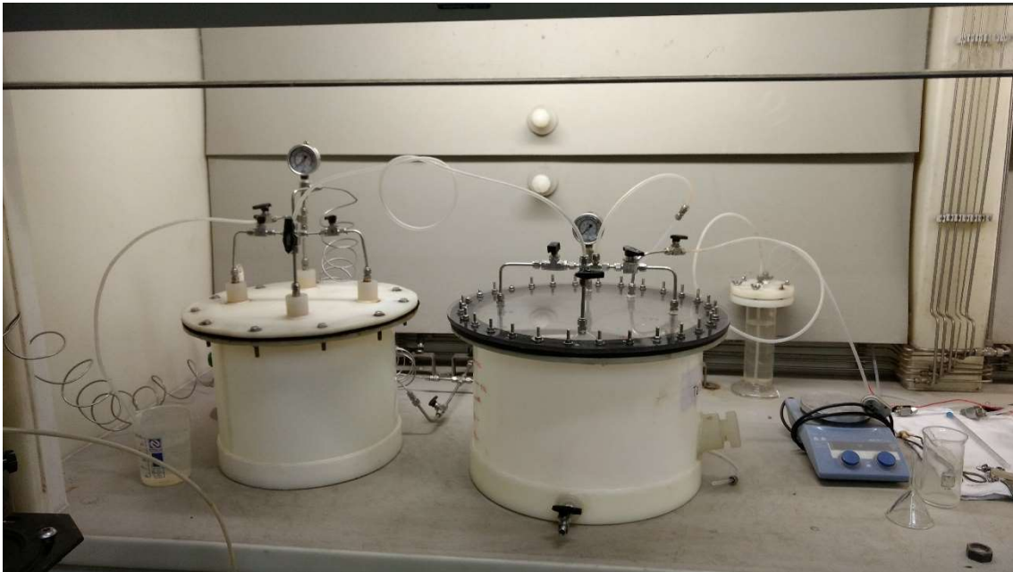
Figura 48 – vasos utilizados no ensaio, a direita o vaso com os corpos de prova e a esquerda o vaso utilizado para purgar a solução.
