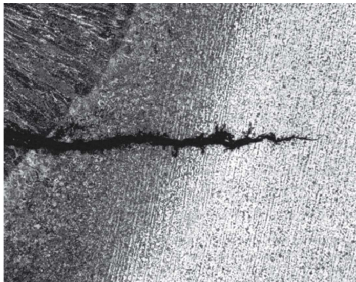
Figura 16 - Trincamento SSC em aço A-516 resistente ao HIC (ver item 4). A trinca nucleada na ZTA propaga no metal base (ALVISI, 2010).
