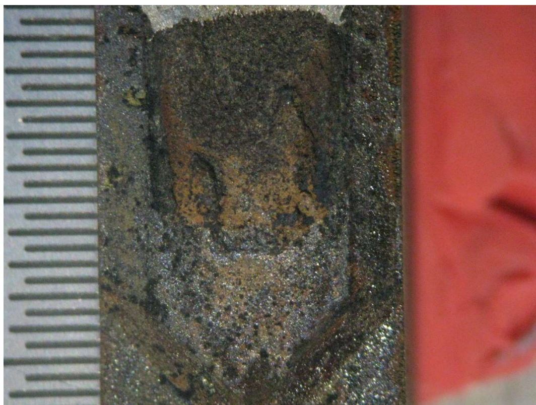
Figura 53 – Exemplo de corpo de prova com trinca de corrosão sobre tensão.
