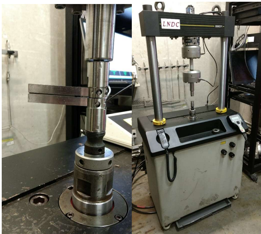
Figura 46 - Máquina servo hidráulica e garra utilizada para prender os corpos de prova na máquina.
