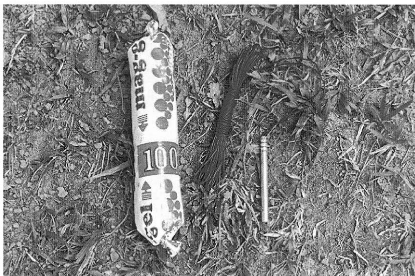
Figura 19 - Explosivo sísmico e espoleta – Fonte de energia utilizada em sísmica terrestre.
