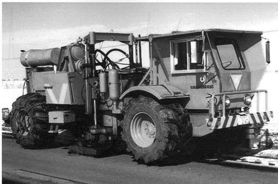
Figura 20 – *Vibroseis* (vibrador) – Fonte de energia utilizada em sísmica terrestre.
