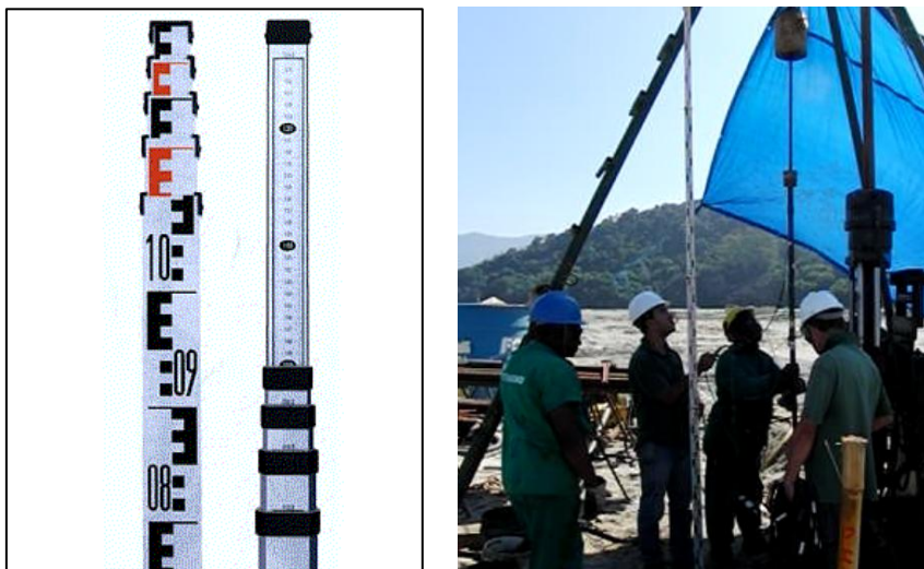
Figura 3.5 – (a) mira topográfica, (b) utilização na campanha
