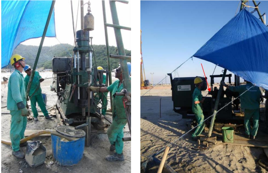
Figura 3.4 – Sistema corda-guincho usado para levantar e lançar o martelo: (a) vista frontal, (b) vista lateral.
