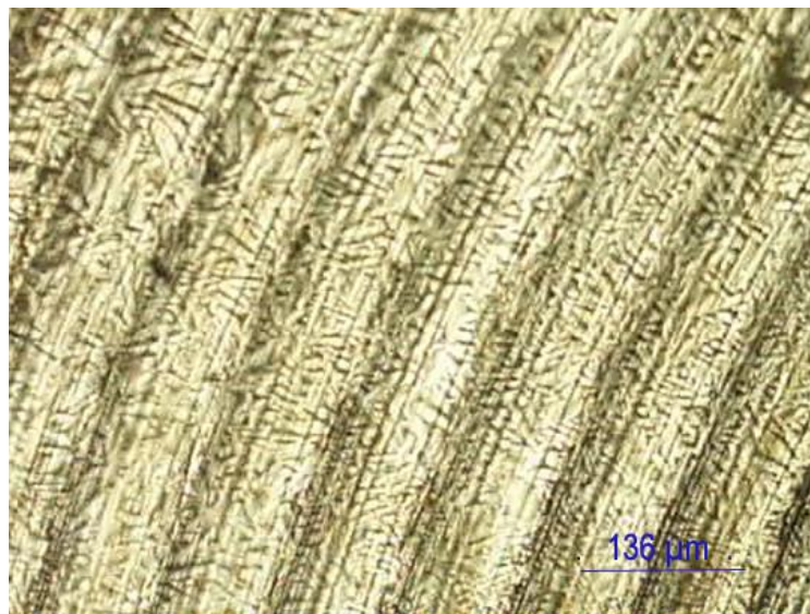
Figura 28: Liga de Ni-Ti usinada a 15m/min com ataque químico aumento de 100x.
