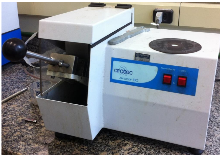
Figura 20: Máquina de corte Arocor com fluido refrigerante.
