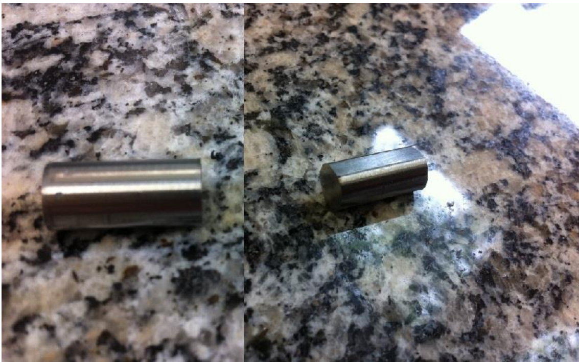
Figura 21: Na esquerda a amostra cortada da barra sem usinagem, na direita amostra polida para referência.
