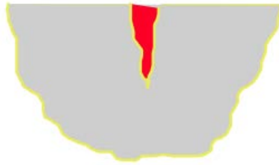
Figura 5.2.9 - Remoção do excesso de líquido da superfície
