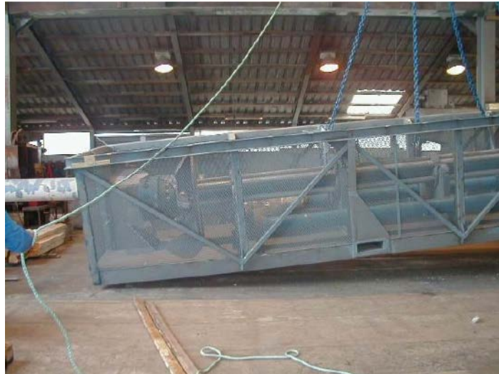
Figura 6.3.1 - Container Offshore realizando o Teste Vertical de Impacto
