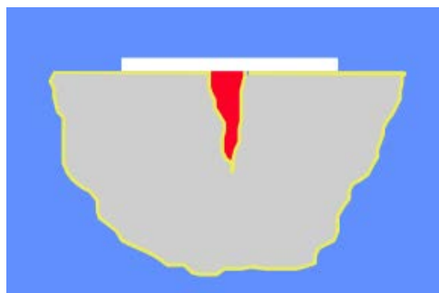
Figura 5.2.10 - Aplicação do revelador e observação da indicação
