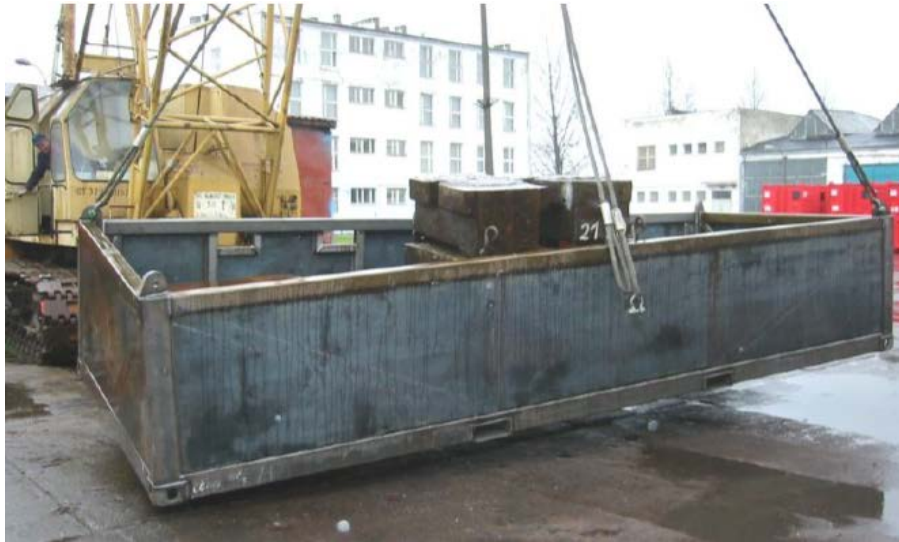
Figura 6.2.1 - Container Offshore sendo içado por 2 Pontos
