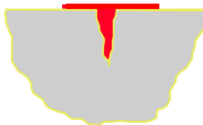
Figura 5.2.8 - Tempo de penetração do líquido na descontinuidade
