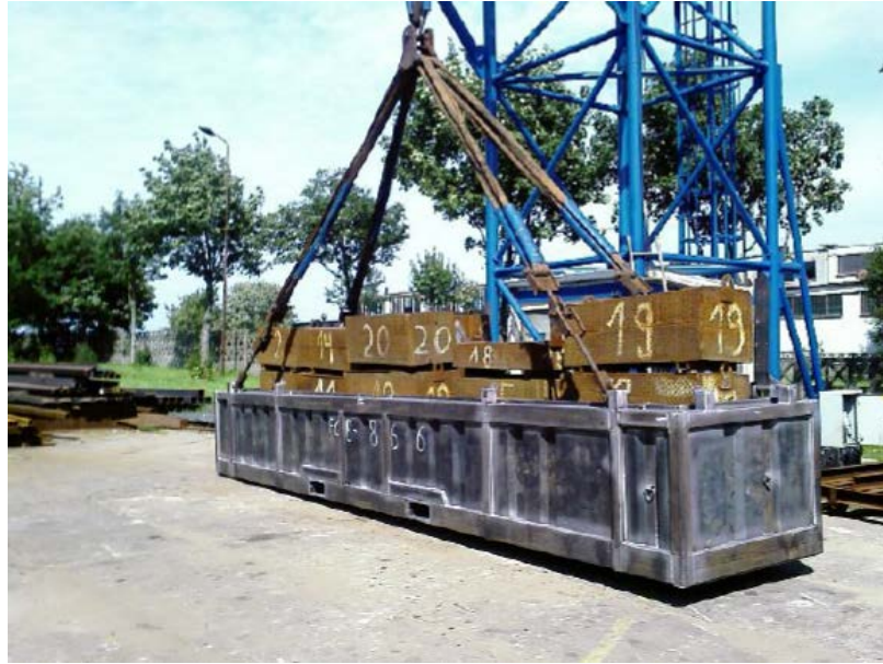
Figura 6.1.1 - Container Offshore sendo içado por 4 Pontos
