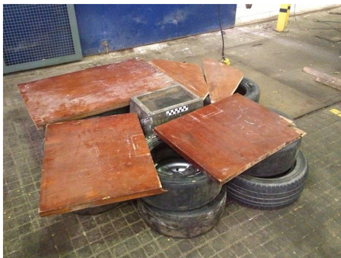
Figura C.6: Imagem da proteção ao redor da bigorna.
