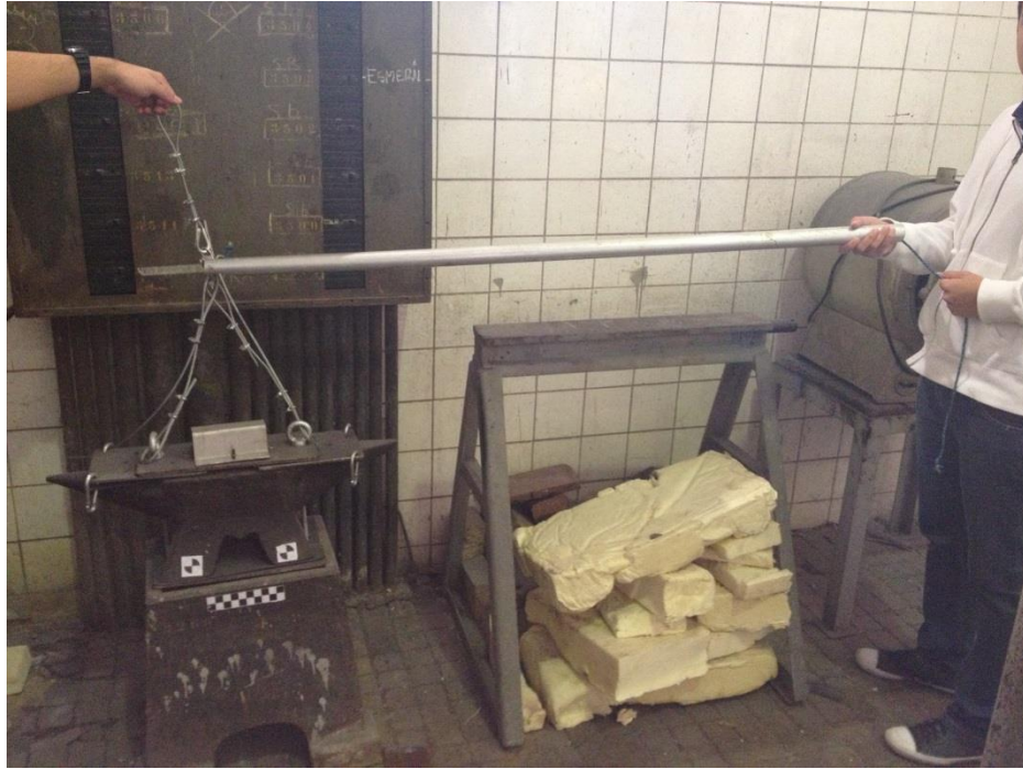
Figura C.4: Ilustração de como o operador é capaz de acionar o mecanismo à distância.
