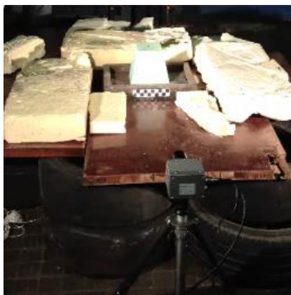
Figura C.7: Imagem obtida antes da realização do ensaio 4. É possível ver a câmera de alta velocidade posicionada, e também as espumas de poliuretano posicionadas ao redor do alvo, como proteção extra.
