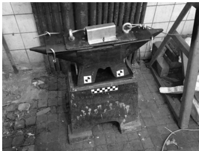
Figura C.5: Imagem da massa de queda utilizada, em cima do apoio rígido.
