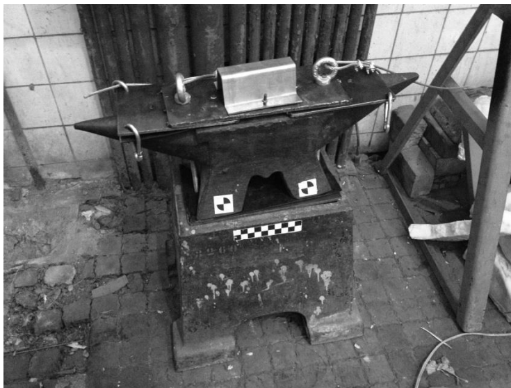
Figura 8.2: Imagem da massa de queda utilizada, em cima do apoio rígido.
