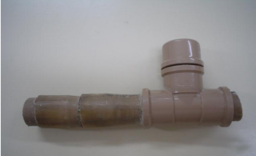
Figura 20 - Uso de bolsas para extensão de tubulação, provocando vazamento
