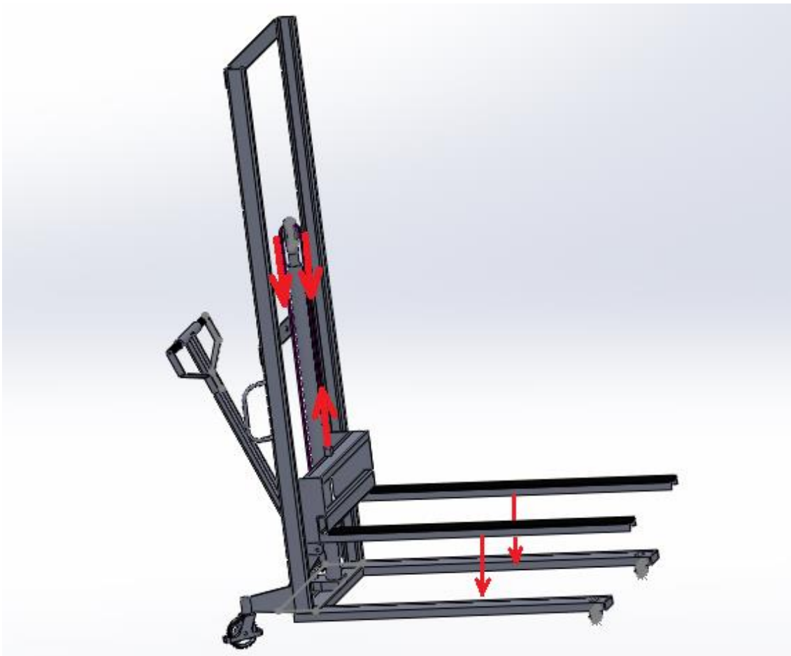
Figura 5.36: Análise das forças atuando na empilhadeira
