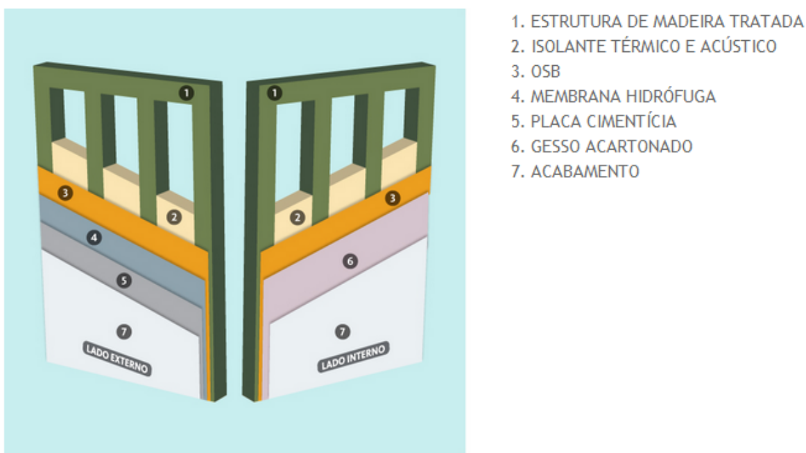
Figura 11 - Componentes Parede Wood Frame FONTE: www.tecverde.com.br
