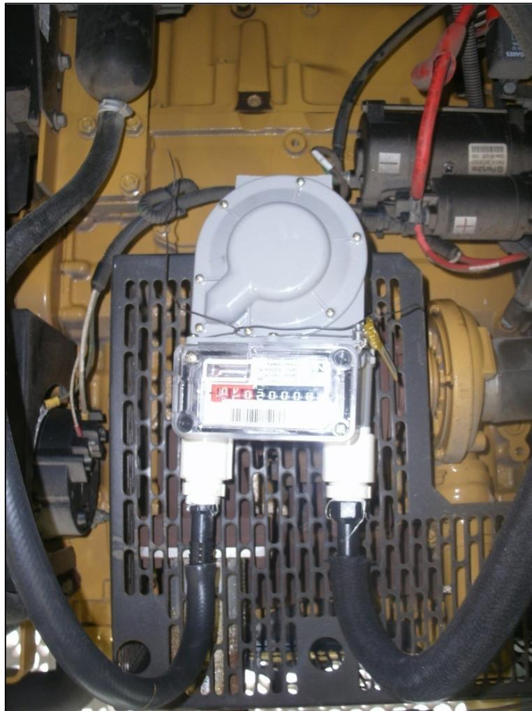
Figura 3.4 Medidor de vazão de GNV e biogás
