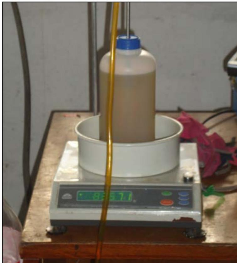
Figura 3.5 Medidor de consumo de gasolina
