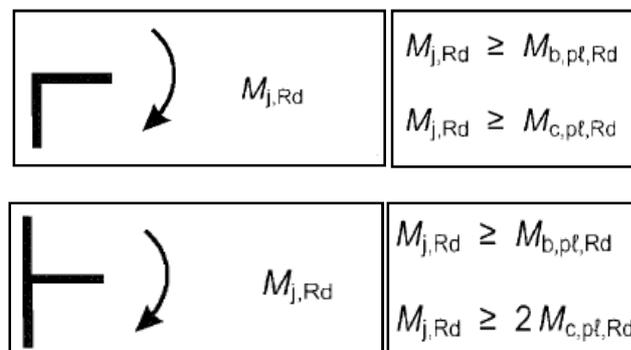
**Figura 2.11 - Limite quanto à resistência total [EUROCODE 3 (2010)]**
