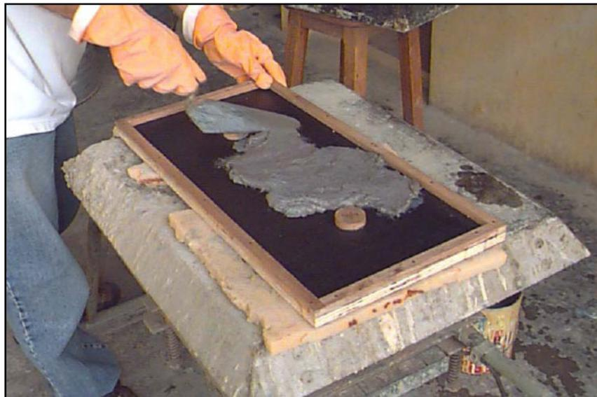
**Figura 2.60 - Moldagem da almofada de apoio do modelo 1.3 [MIOTTO (2002)]**
