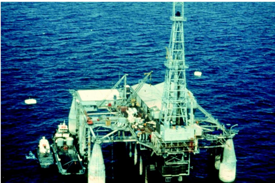
**Figura 7 - Blue Water Rig n° 1. Primeira sonda semi-submersível**
