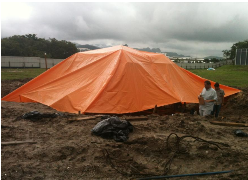
Figura 4.22 – Cobertura da área de ensaio para proteção do sistema de medição.
