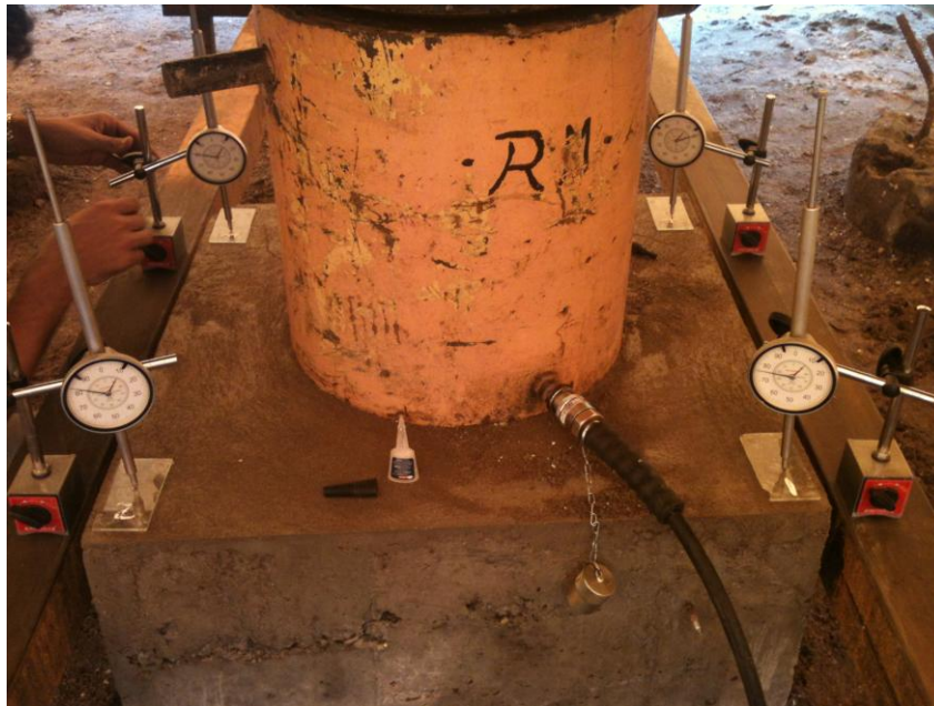
Figura 4.20 – Instalação dos extensômetros.
