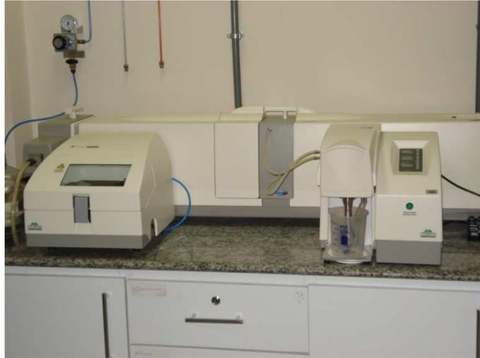
Figura 14 - Granulômetro a laser *Malvern*
