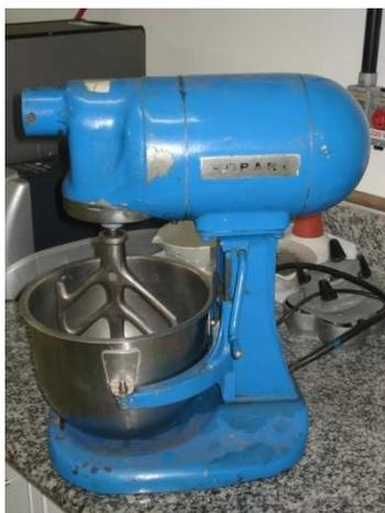
Figura 13 - Misturador prescrito pela NBR 7215 (1996) para produção de argamassas para determinação da resistência do cimento
