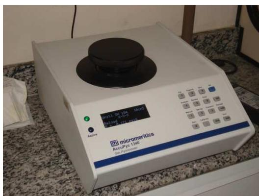
Figura 17 - Picnômetro para determinação das massas específicas dos materiais cimentícios
