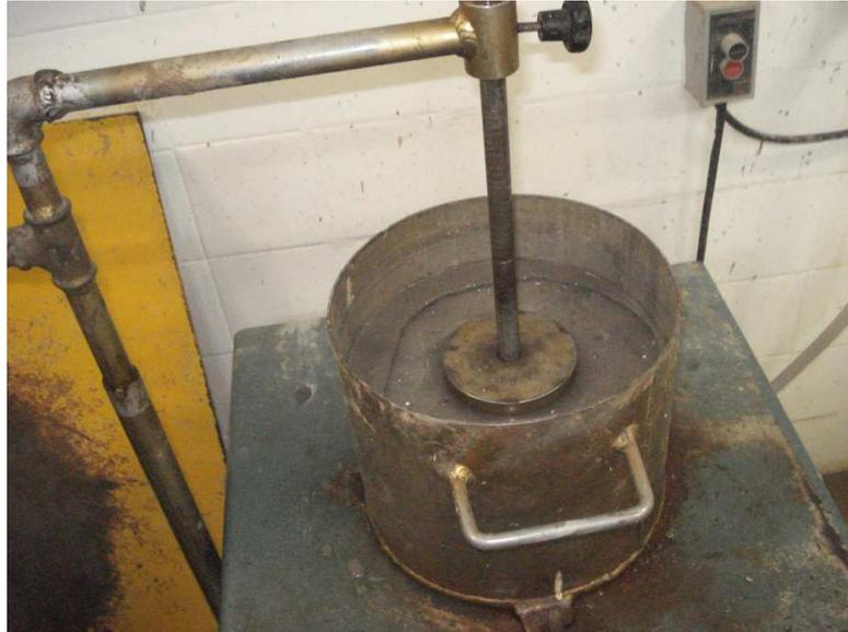
Figura 26 – Realização de ensaio de determinação do tempo de VeBe
