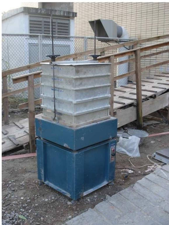
Figura 19 - Peneiramento para determinação da composição granulométrica das britas
