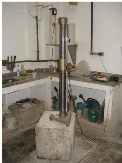
Figura 23 - Configuração do ensaio de compressão com vibração
