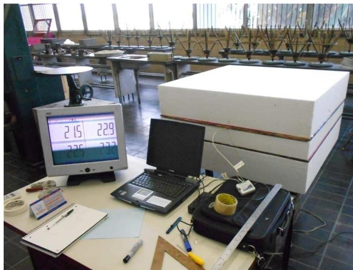
Figura 34 - Configuração do ensaio em andamento, com o sistema de isolamento térmico fechado
