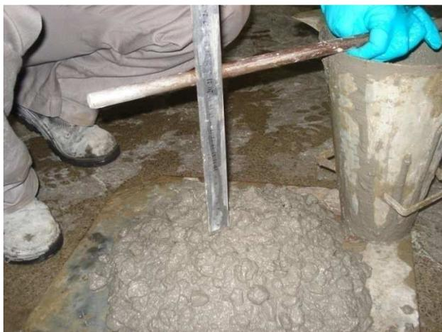
Figura 25 – Medição do abatimento de tronco de cone
