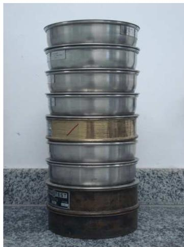
Figura 18 - Peneiramento para determinação da composição granulométrica da areia
