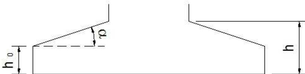
Figura 69 - Esquema da sapata mostrando as dimensões  $h$  (altura total da sapata),  $h_0$  (altura do paralelepípedo) e o ângulo  $\alpha$  (entre a superfície inclinada do tronco de cone e a horizontal)
