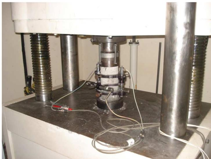
Figura 28 – Configuração do ensaio mecânico de compressão simples
