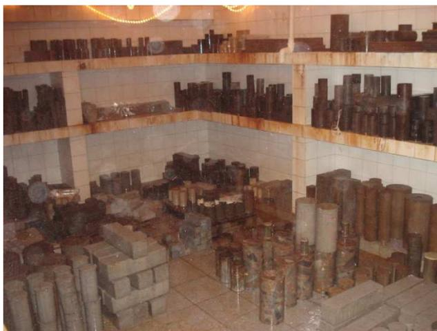
Figura 24 – Cura dos concretos produzidos em câmara úmida
