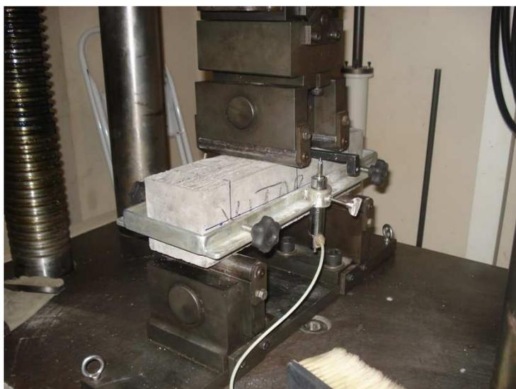
Figura 29 – Configuração do ensaio mecânico de flexão
