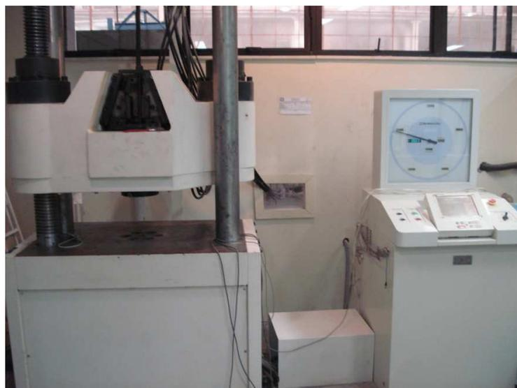
Figura 27 – Prensa Shimadzu servo-controlada, modelo UH-F 1000 kN
