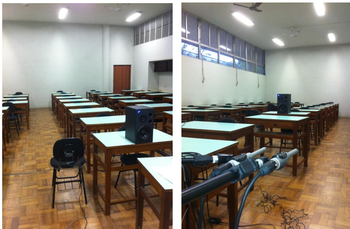
Figura 6.11 Fotografias da Sala 2 mostrando os microfones e caixa de som utilizados nos testes
