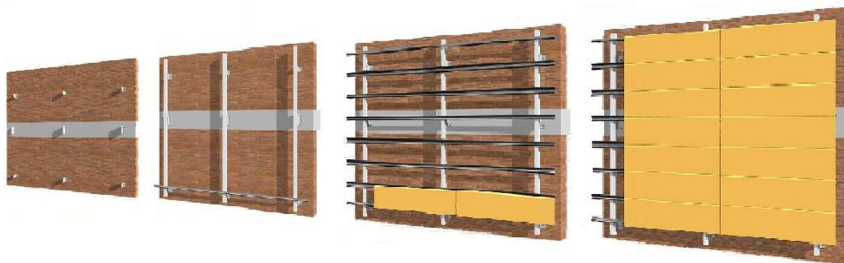
Figura 20:seqüência executiva de FDV apoiada sobre pano externo. Da esquerda para a direita: fixação dos elementos de ancoragem, fixação dos perfis de sustentação, colocação do revestimento externo, aspecto final
