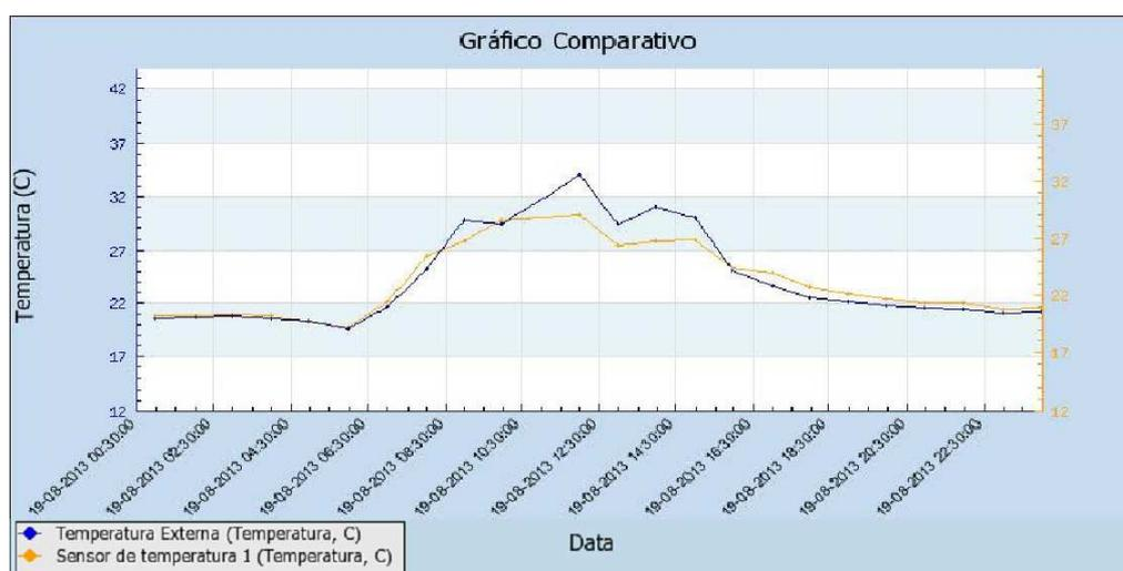
Figura 5.2 – Comparativo temperatura registrada pelo sensor 1 e por um termopar.
