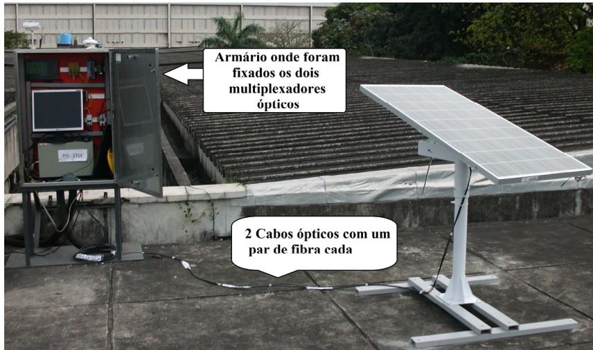
Figura 4.5 – Ligação dos sensores no painel solar com os multiplexadores ópticos instalados dentro do armário.
