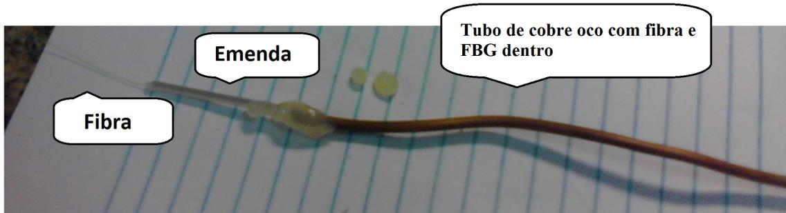
Figura 4.2 – Tubo de cobre para proteger a FBG
