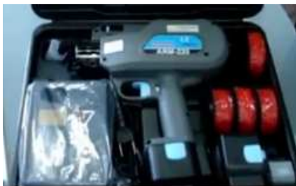
Figura 97 - Amarradeira automática ( http://www.foco-is.com/ , 2013)
