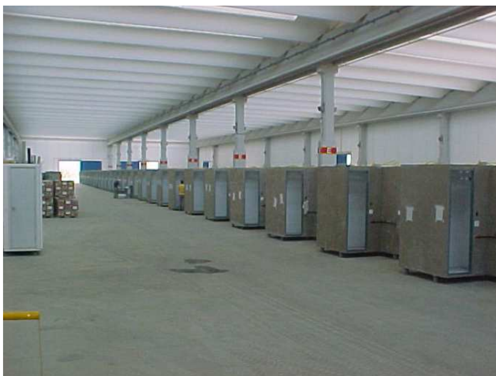
Figura 134 - Linha de montagem de banheiro pronto (LOPES, 2005)
