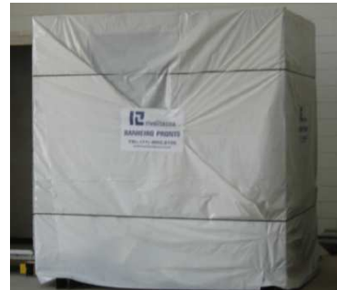
Figura 138 - Banheiro embalado para o transporte (LOPES, 2005)
