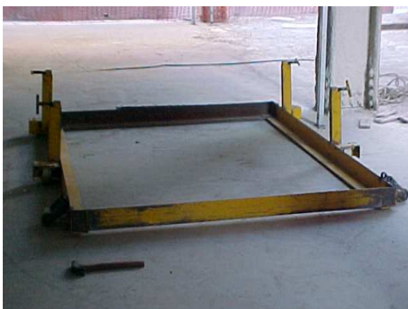
Figura 142 - Carrinho para transporte horizontal no pavimento (LOPES, 2005)
