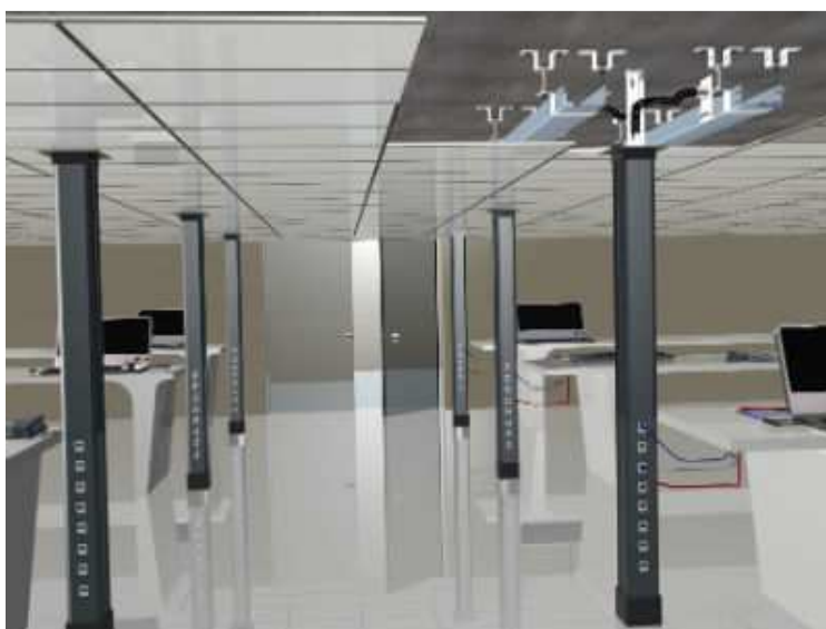
Figura 161 - Instalação aparente utilizando-se postes ( http://www.valemam.com.br/ , 2013)
