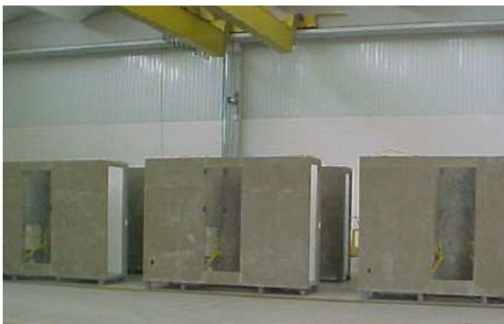
Figura 135 - Linha de montagem de banheiro pronto (LOPES, 2005)
