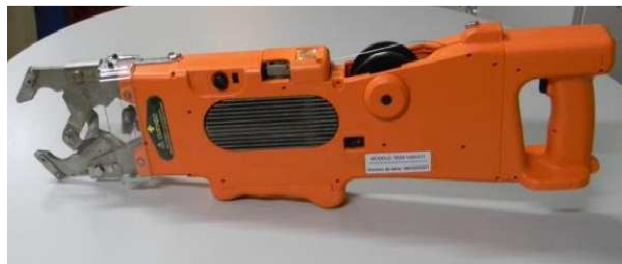
Figura 98 - Amarradeira automática ( http://intersilos.com.br/ , 2013)
