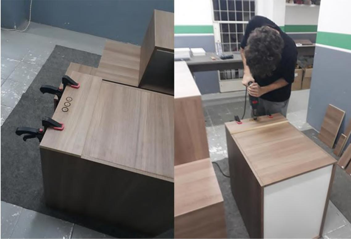
Figura 100 e figura 101- Guia preso com duas braçadeiras para a furação dos Baús
