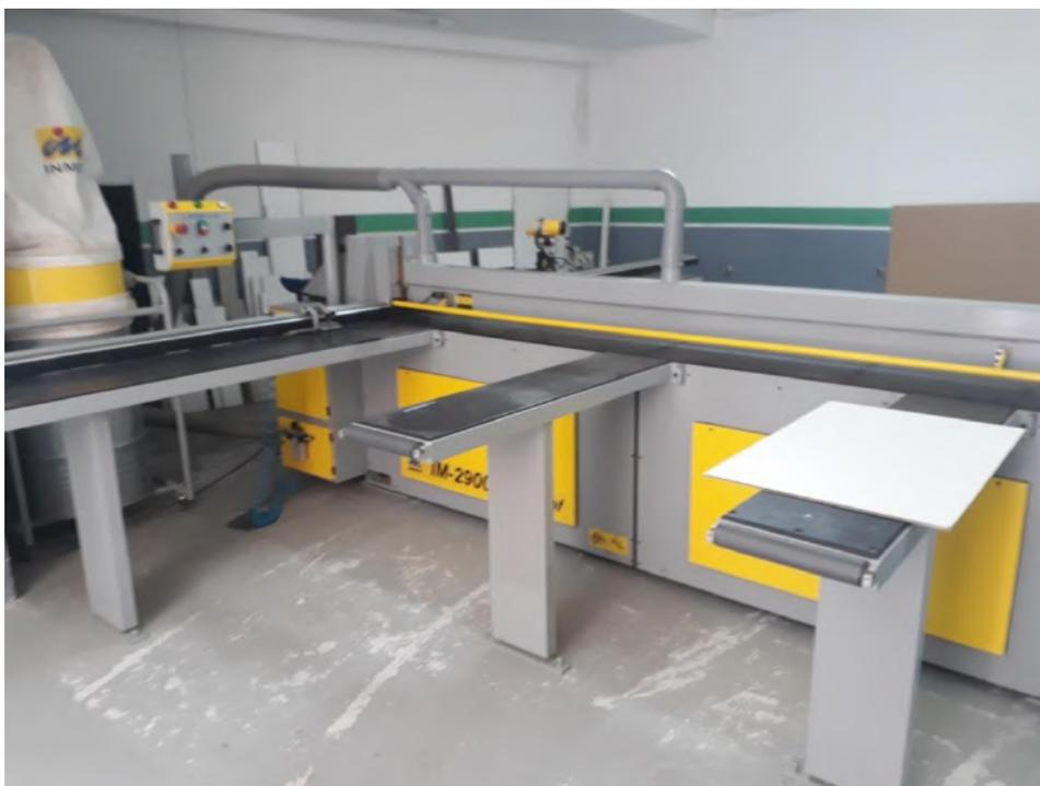
Figura 93 - Seccionadora horizontal que foi usada para o corte do MDF.
