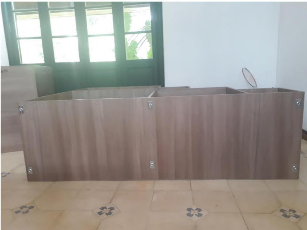
Figura 104 - Móvel virado para a aplicação da sapata.
