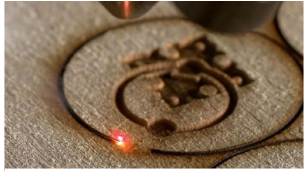
Figura 69 – Corte de madeira a laser Foto de: Sculpteo Fonte: www.usinenouvelle.com
