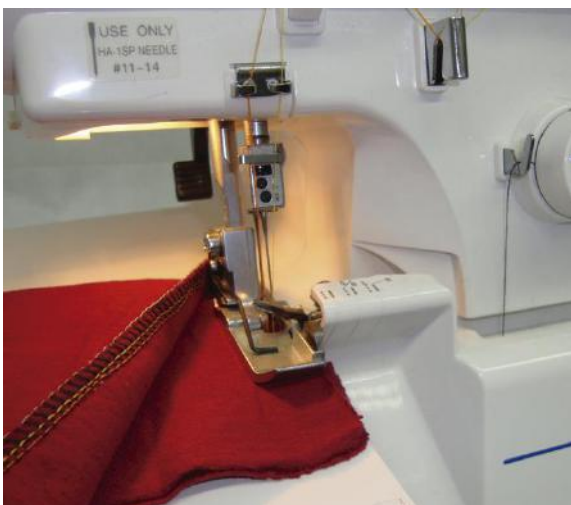
Figura 109 - Máquina realizando costura em overloque e costura reta simples e pesponto. Fonte: (Máquina) www.janome.com.br ; (Pontos) www.singer.com.br .
