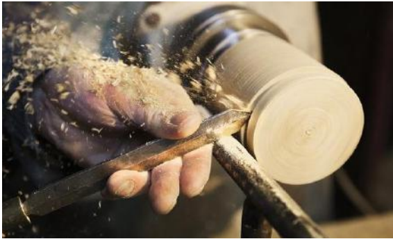
Figura 68 – Torneamento de bloco de madeira Fonte: www.charles-keith.co.uk
