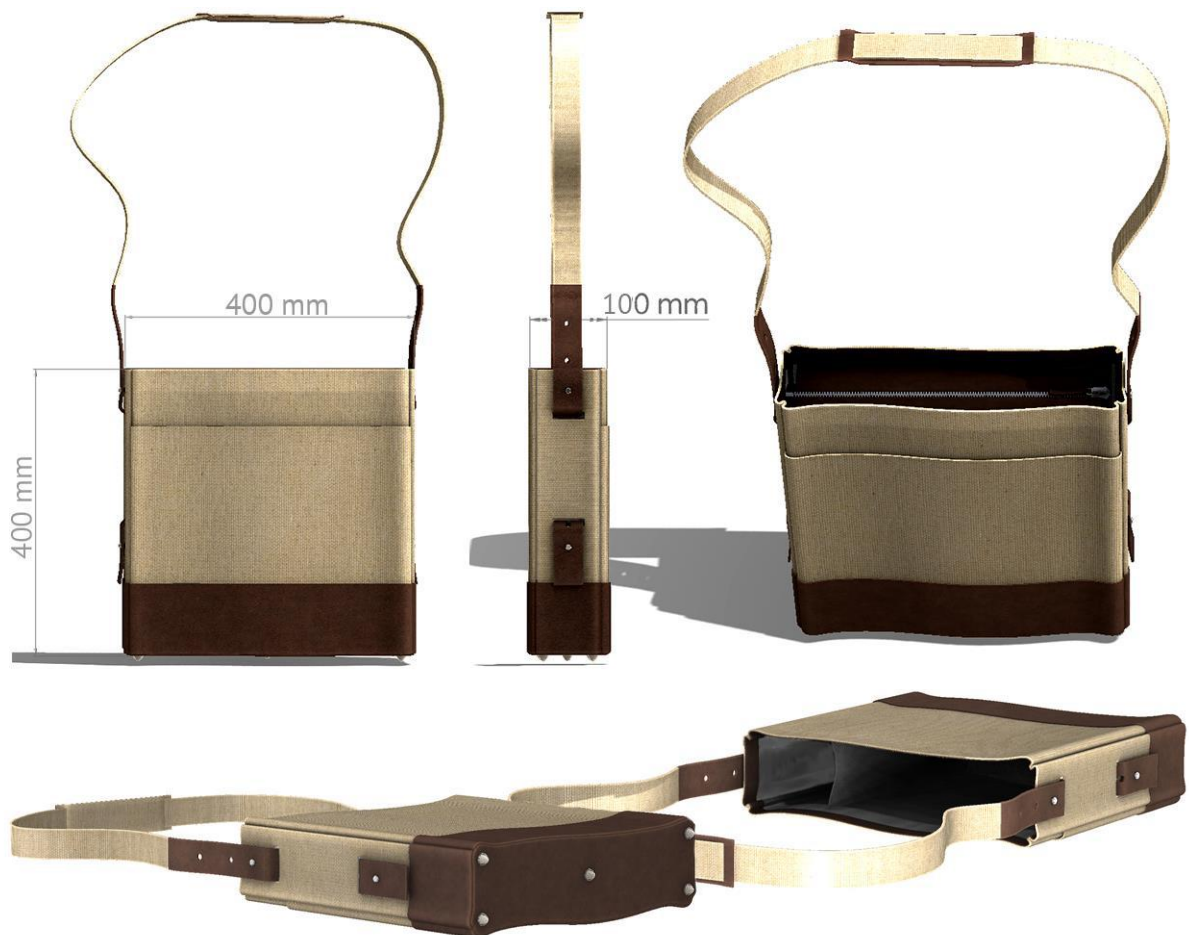
Figura 104 - Medidas gerais e detalhes do interior e fundo da bolsa. Fonte: elaboração Própria
