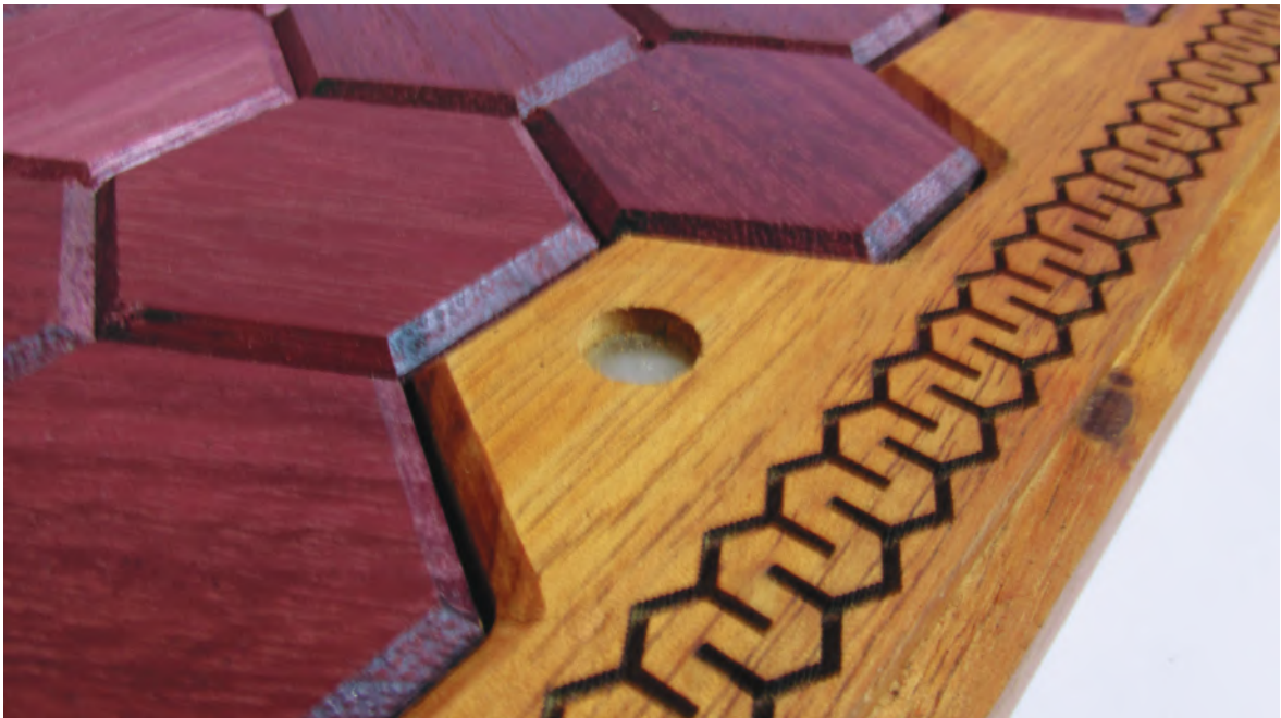
Figura 116: detalhe da fixação dos ímãs nas laterais.
