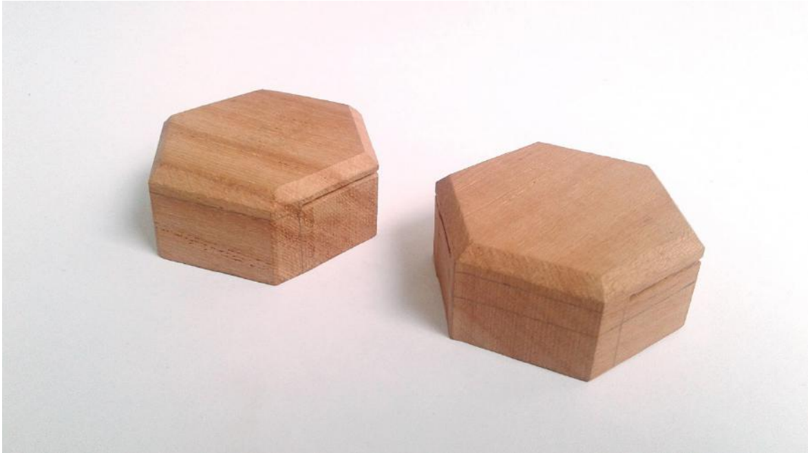
Figura 73: fibras paralelas e concorrentes à face de apoio.
