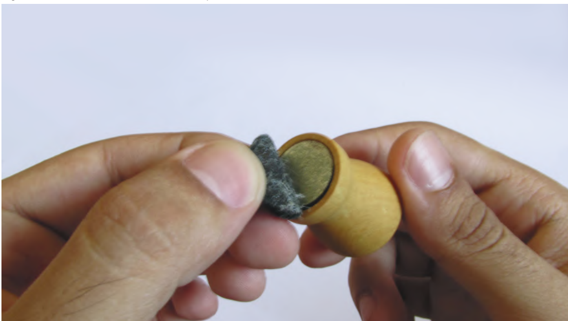
Figura 128: detalhe dos ímãs e do feltro nos peões.
