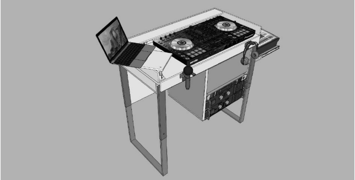
Figura 85 - Acomodação dos Periféricos 1.2
