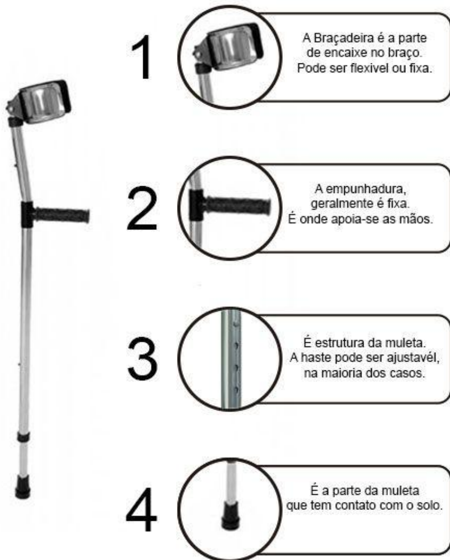
Figura 19 - Composição básica de uma muleta canadense / Fonte: Desenvolvido pelo autor
