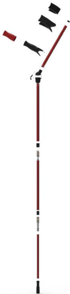
Figura 44 - Muleta explodida / Fonte: Desenvolvido pelo autor
