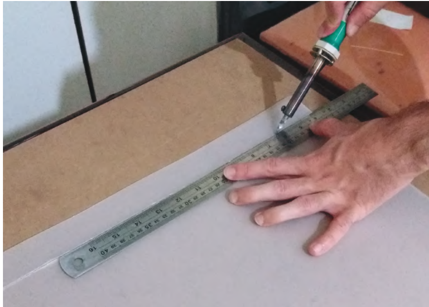
Figura 93 - Selagem dos bolsões por um ferro de solda. Fonte: elaboração própria.
