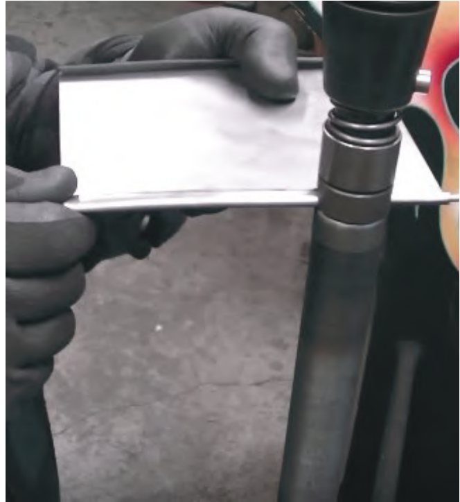
Figura 85 - A máquina em uso, fazendo a mesma dobra proposta pelo projeto. Fonte: https://youtu.be/QOy_QWfHMXI?t=5m10s
