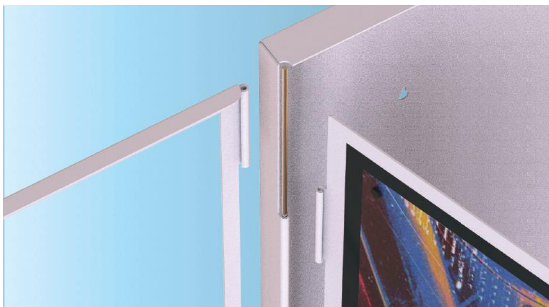
Figura 83 - Detalhe da dobradiça do quadro. Fonte: elaboração própria.
