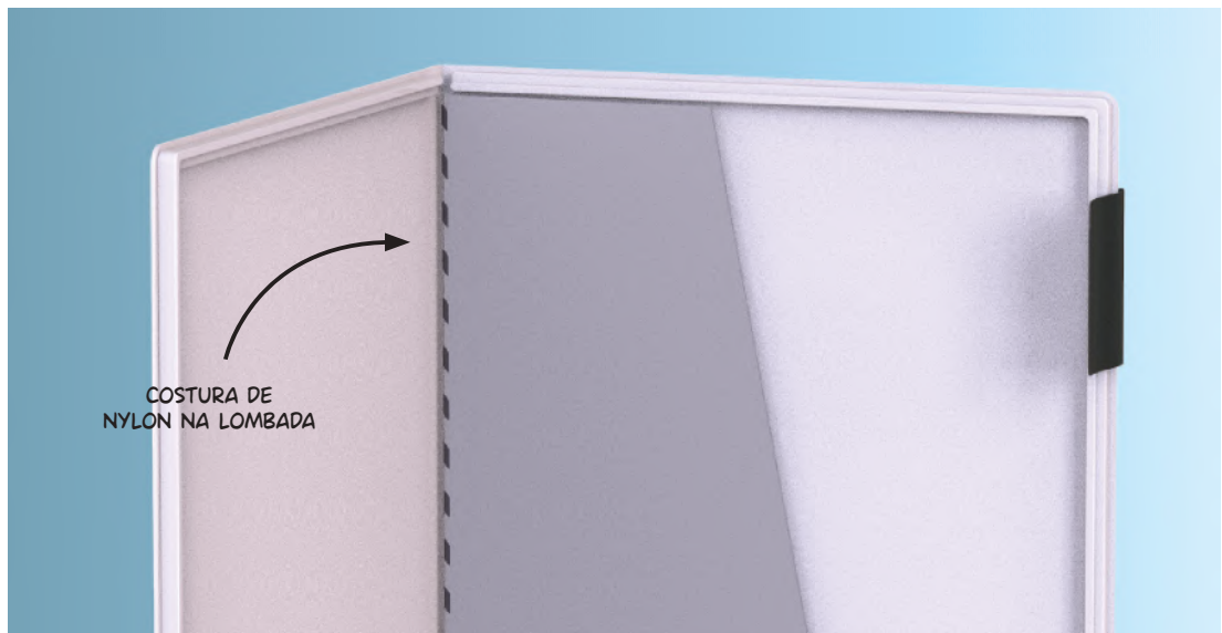
Figura 88 - Detalhe da costura dos bolsões. Fonte: elaboração própria.
