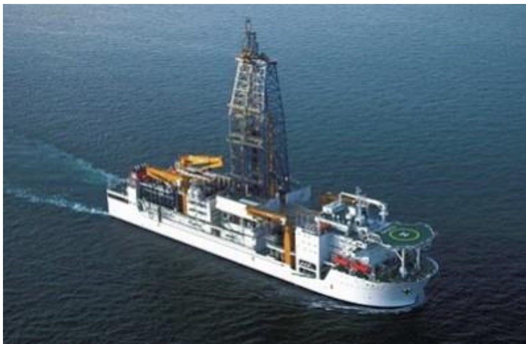
Figura 2.4: Plataforma Navio-Sonda. Fonte THOMAS (2001)
