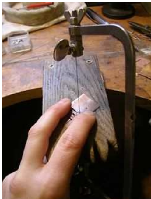
Figura 70 - Corte de chapas metálicas.
