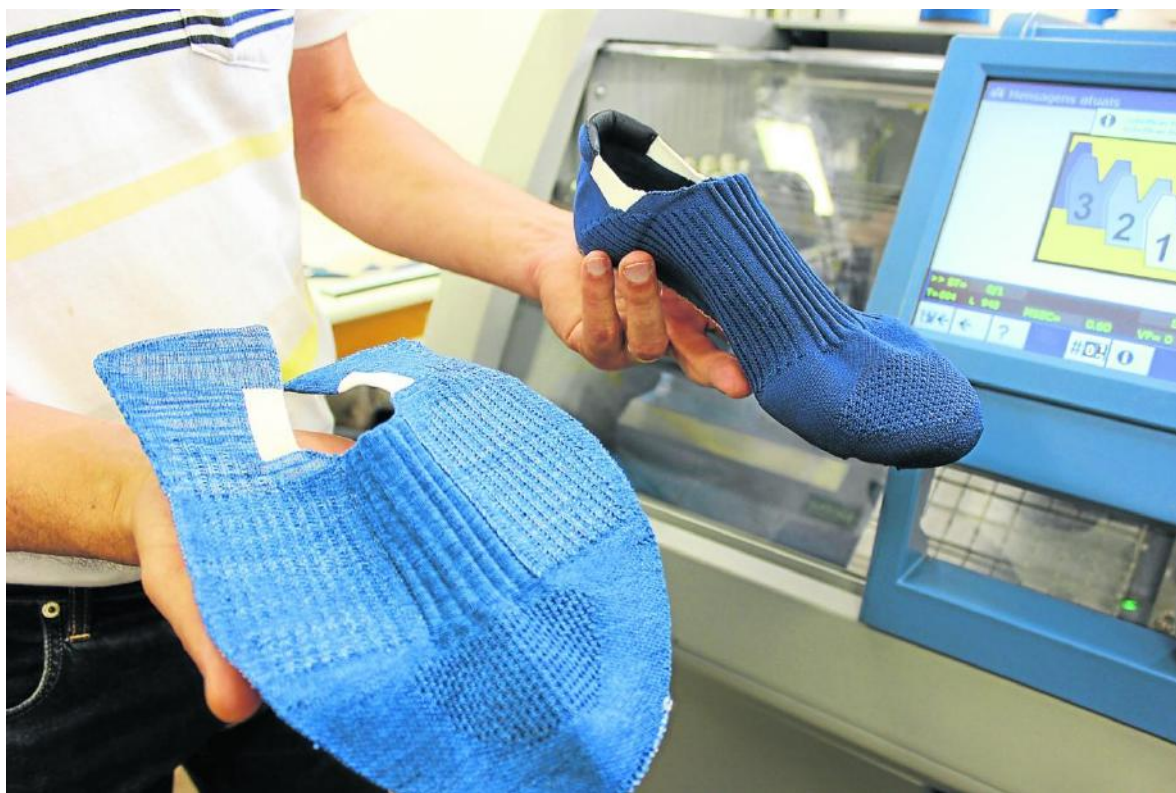
Figura 25 - Exemplo de produção de cabedal de knit Fonte: exclusivo.com.br
