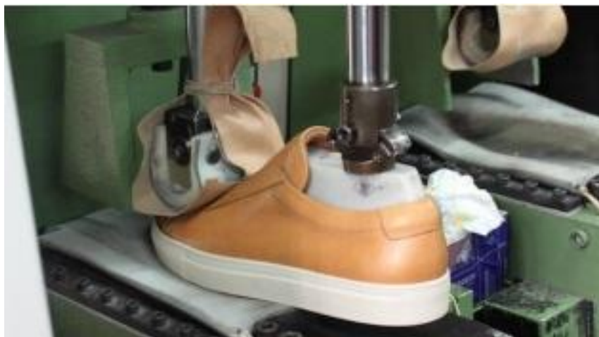
Figura 34 - Exemplo de colagem da sola ao cabedal Fonte: brasilescola.uol.com.br
